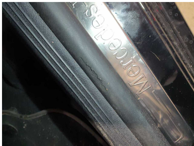
Damage 8: Door - front left side: Door seal - Broken / torn - Replace
