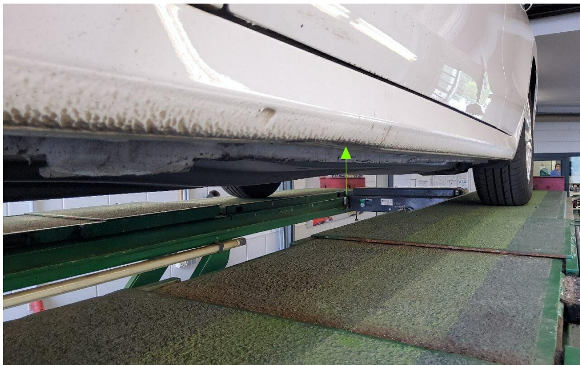
Bild 17 : Schweller links deformiert
