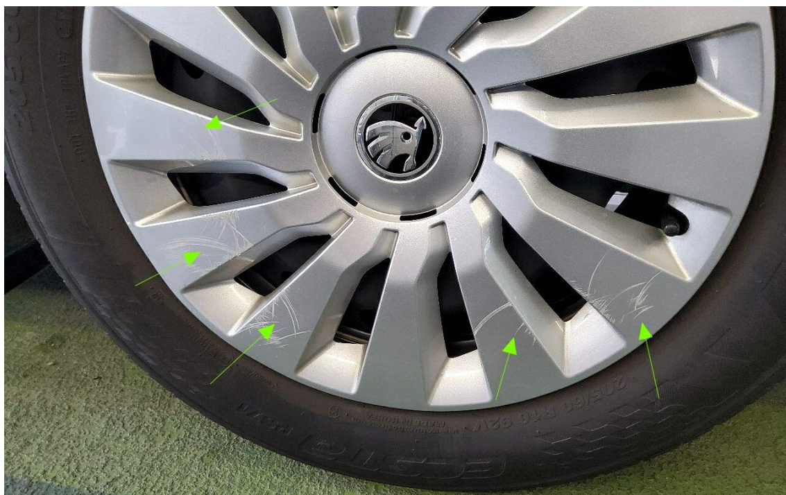
Bild 12 : Radzierblende hinten links verschrammt
