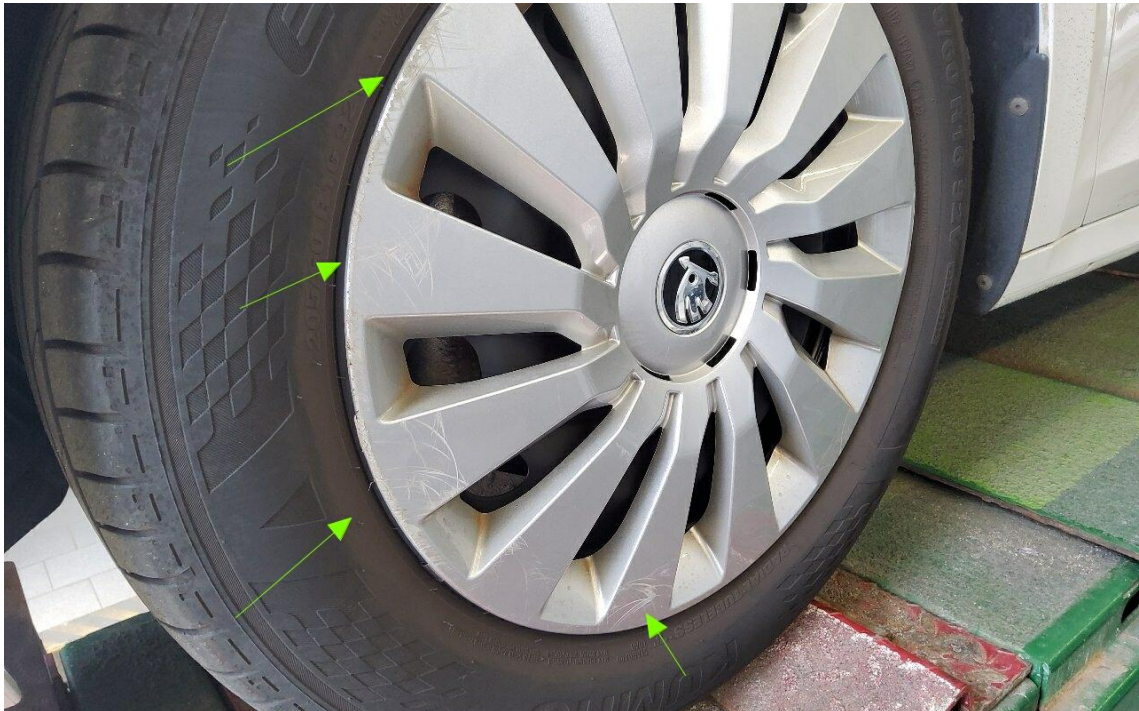
Bild 7 : Radzierblende vorne links verschrammt
