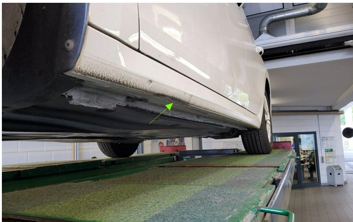
Bild 16 : Schweller links deformiert
