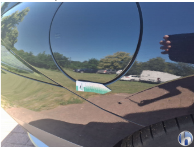
7. Seitenwand - Hinten - Rechts Oberflächenkratzer - Aufbereiten / Polieren
