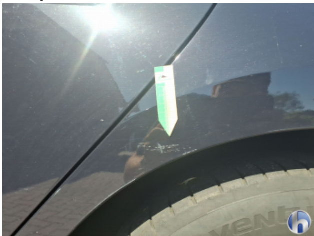
1. Seitenwand - Hinten - Links Kratzer - Smart Repair
