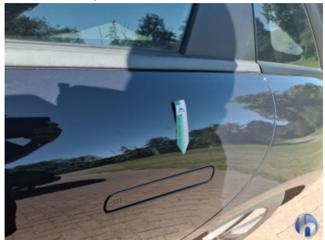
6. Tür Hinten - Links Oberflächenkratzer - Aufbereiten / Polieren
