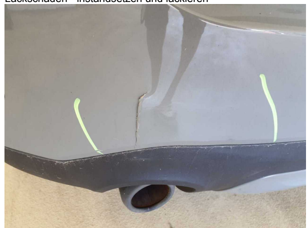
Beschädigung #7: Stossfänger hinten: Stossfänger hinten - beschädigt - erneuern
