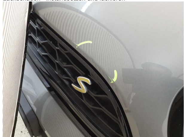
Beschädigung #6: Motorhaube: Motorhaube - Delle / Lackschaden - instandsetzen und lackieren
