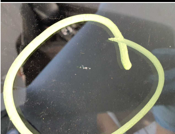
Damage #5: Vehicle glazing: Windscreen with rain sensor (Mit Rissbildung) - Stone chips - Replace
