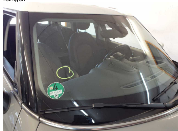
Beschädigung #5: Verglasung: Frontscheibe mit Regensensor (Mit Rissbildung) - Steinschlag - erneuern
