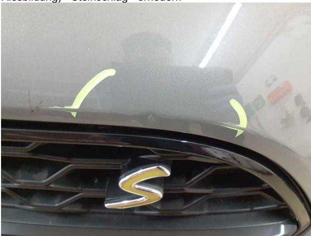
Beschädigung #6: Motorhaube: Motorhaube - Delle / Lackschad... - instandsetzen und lackieren
