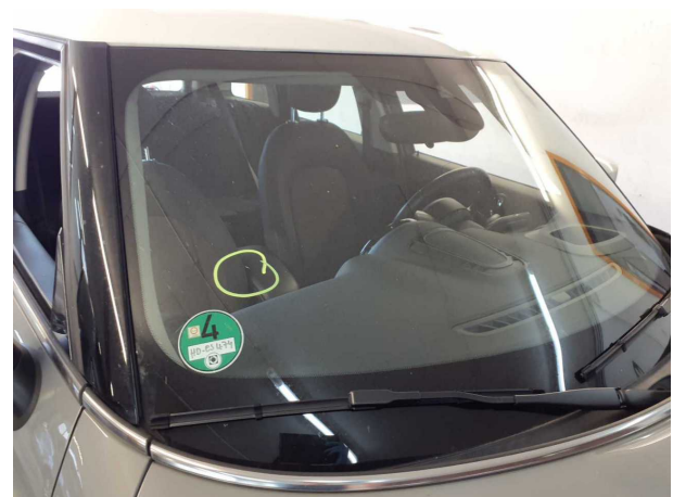
Damage #5: Vehicle glazing: Windscreen with rain sensor (Mit Rissbildung) - Stone chips - Replace
