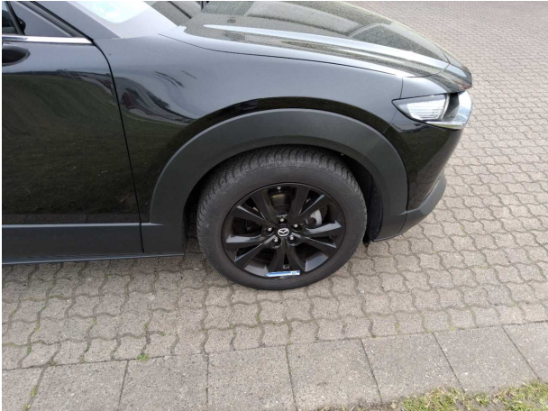
Beschädigung #1: Rad/Reifen: Leichtmetallfelge vorn rechts (Materialabtrag) - Kratzer - erneuern
