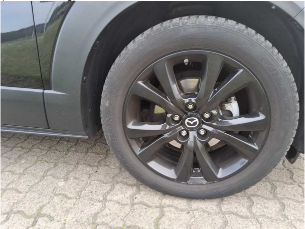
Beschädigung #2: Rad/Reifen: Reifen vorn (Ganzjahresreifen, Profiltiefe <4mm) - entspricht nicht den Leasingvorgaben - erneuern
