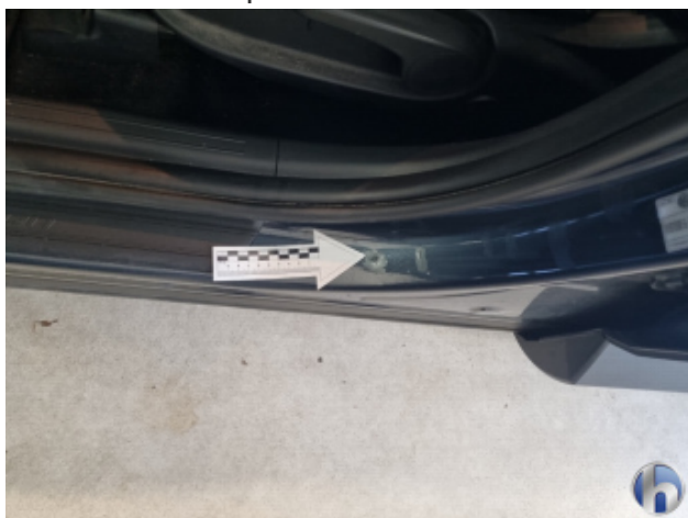
2. B-Säule Mitte - Rechts Delle - Smart Repair
