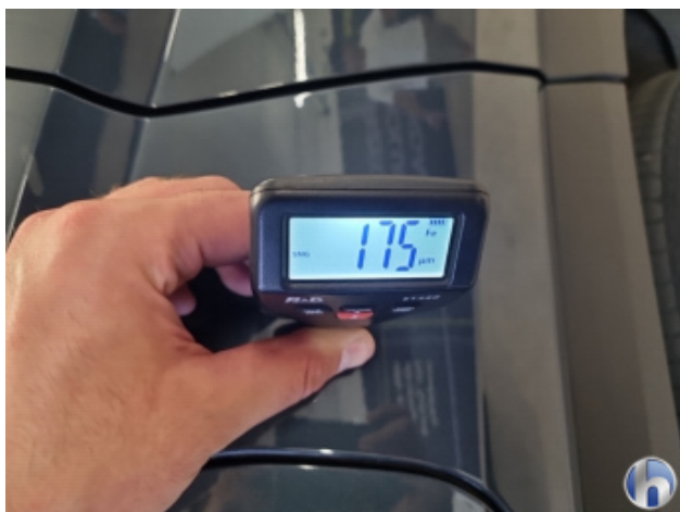
1. Seitenwand - Hinten - Rechts Nachlackiert - Ohne Reparatur
