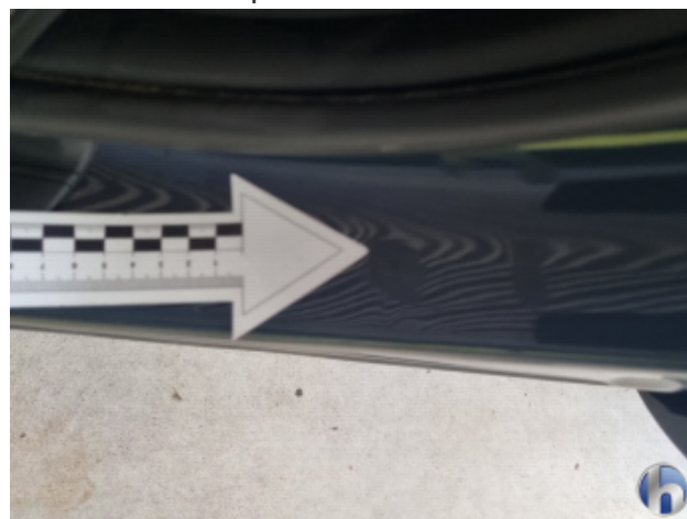
2. B-Säule Mitte - Rechts Delle - Smart Repair
