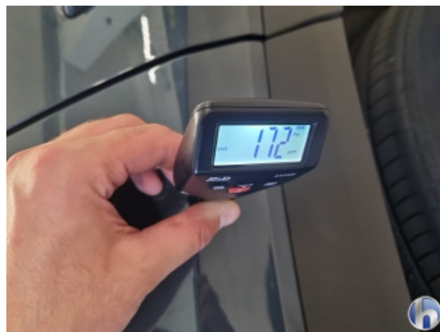
1. Seitenwand - Hinten - Rechts Nachlackiert - Ohne Reparatur
