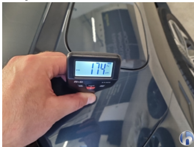
1. Seitenwand - Hinten - Rechts Nachlackiert - Ohne Reparatur
