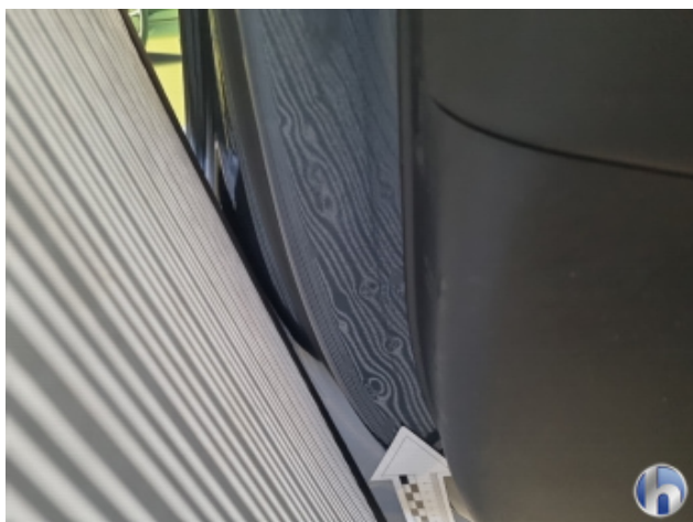
2. B-Säule Mitte - Rechts Delle - Smart Repair
