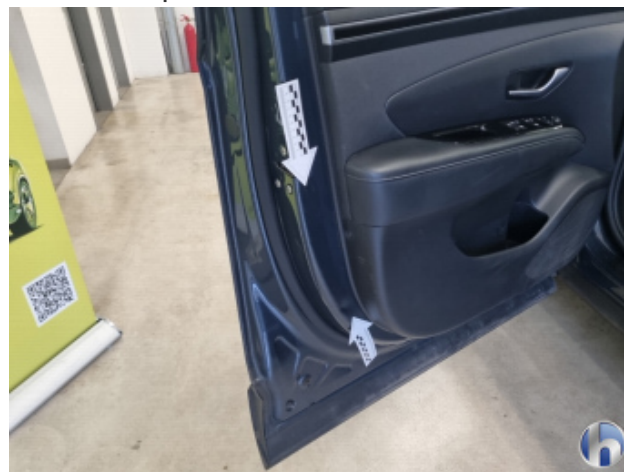
2. B-Säule Mitte - Rechts Delle - Smart Repair
