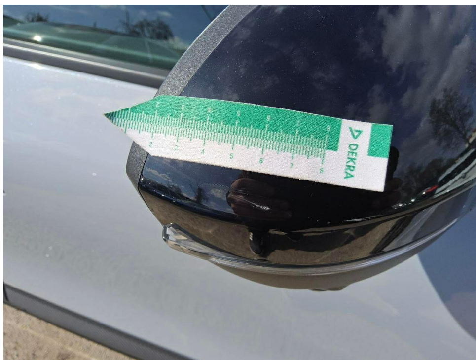
Bild 12 : Außenspiegel rechts Lackierung, verschrammt, smart repair
