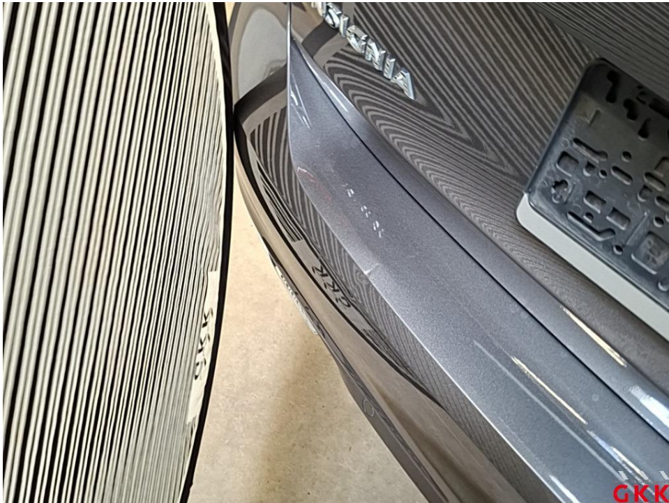
Bild 24 Stoßfänger hinten, Verkleidung -lackiert-, beschädigt, ersetzen
