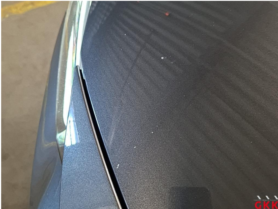
Bild 18 Motorhaube, Steinschlag, lackieren
