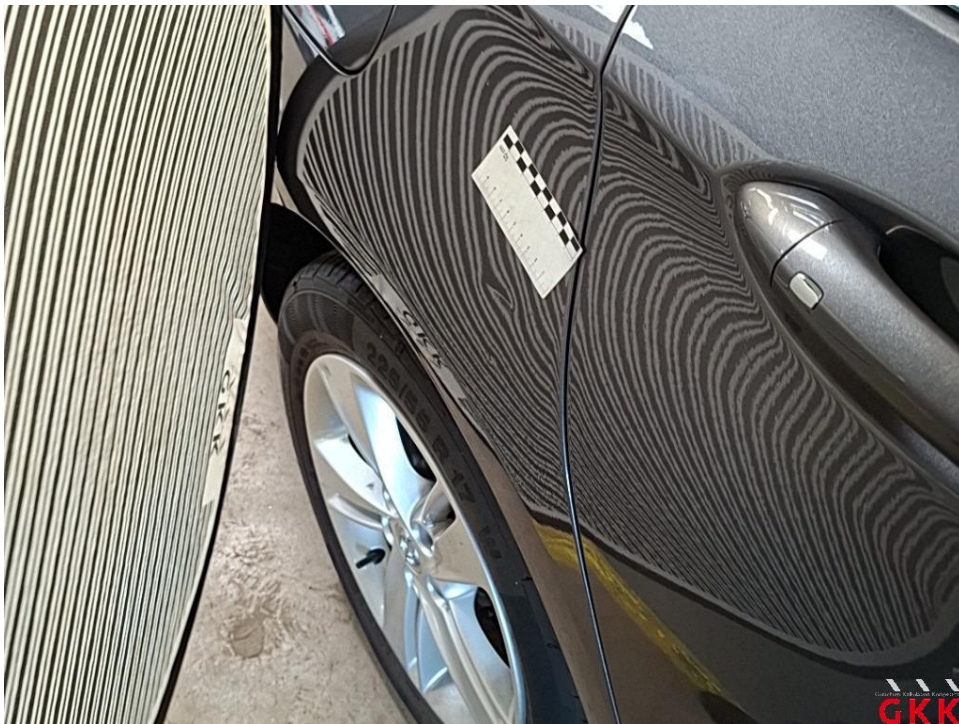
Bild 27 Seitenwand rechts, beschädigt, instand setzen - lackieren
