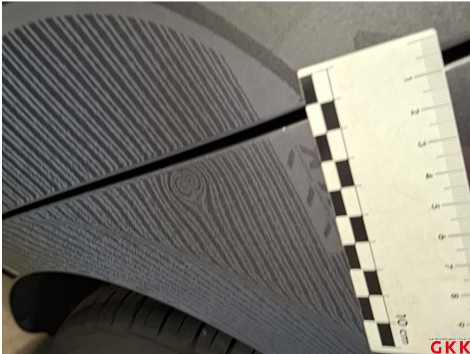
Bild 20 Seitenwand links, beschädigt, instand setzen - lackieren
