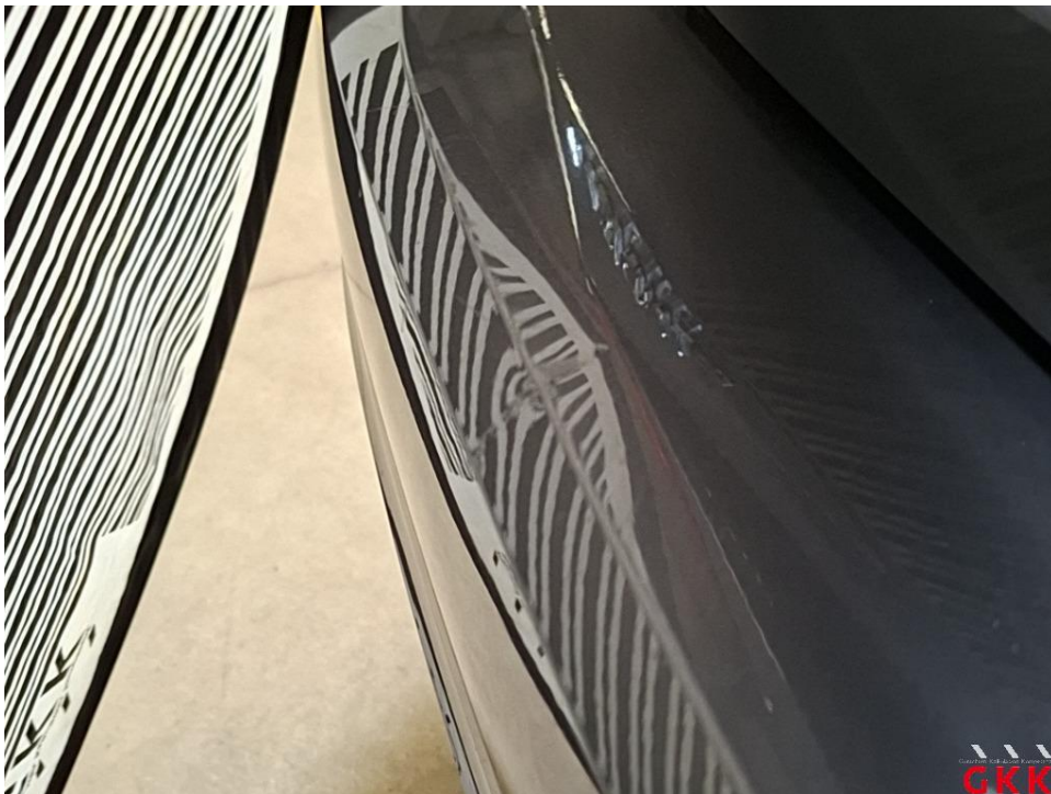
Bild 25 Stoßfänger hinten, Verkleidung -lackiert-, beschädigt, ersetzen
