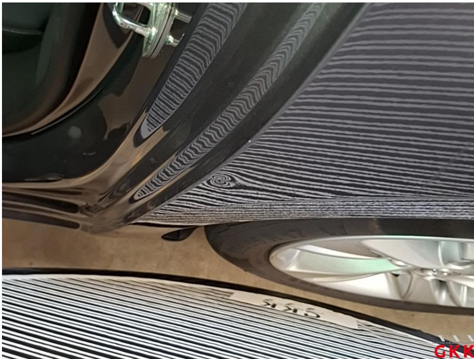
Bild 21 Seitenwand links, beschädigt, instand setzen - lackieren
