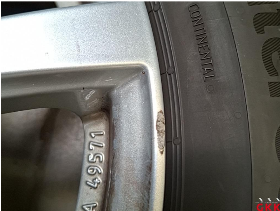
Bild 23 LM-Rad, 1 x beiliegend, Materialabtrag, ersetzen
