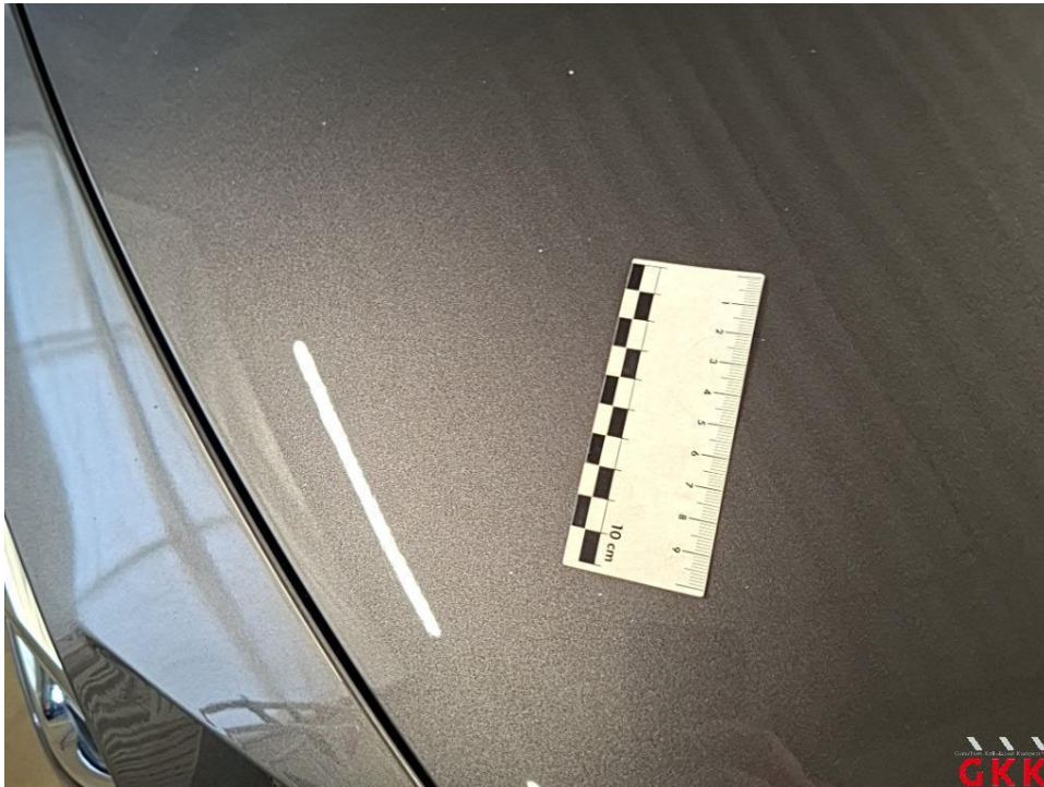
Bild 16 Motorhaube, Steinschlag, lackieren
