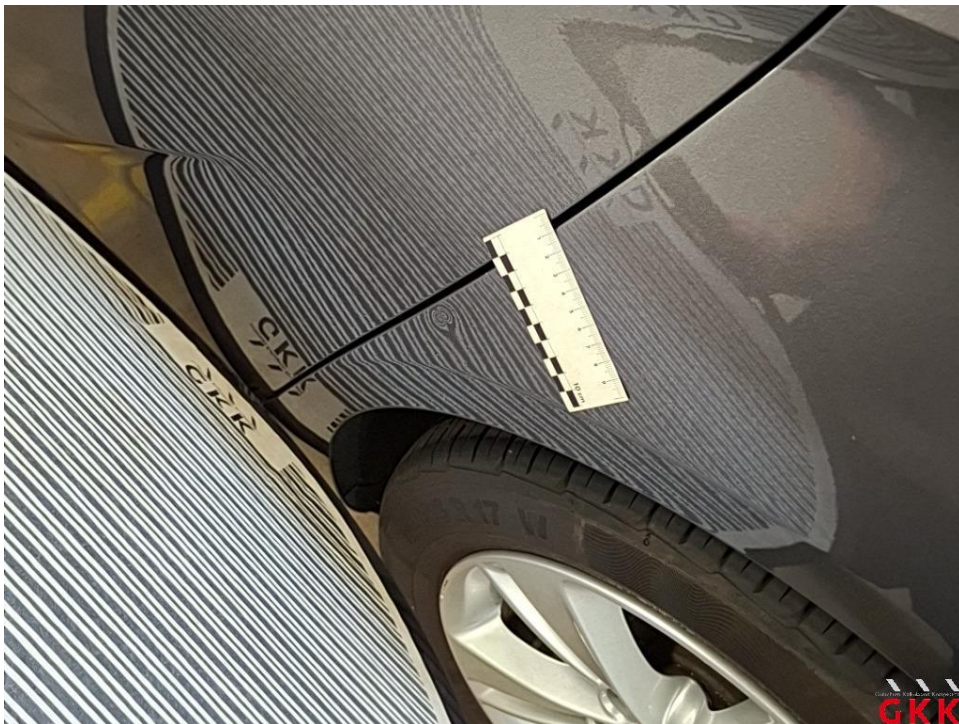
Bild 19 Seitenwand links, beschädigt, instand setzen - lackieren
