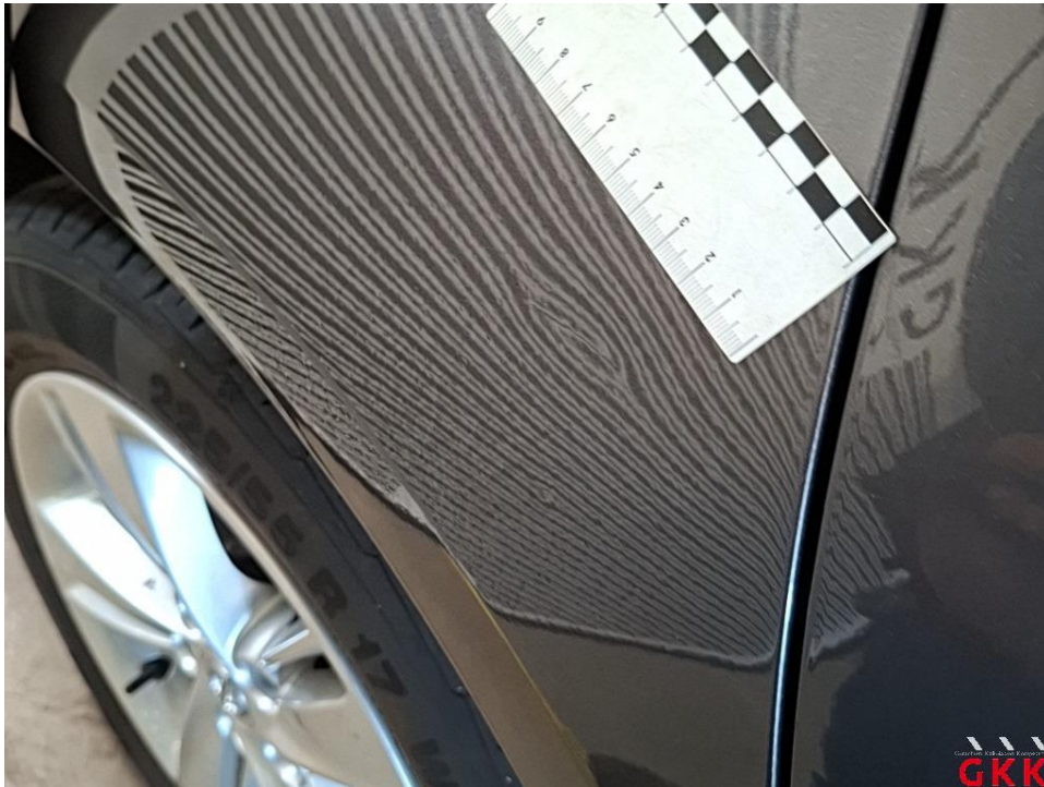
Bild 28 Seitenwand rechts, beschädigt, instand setzen - lackieren
