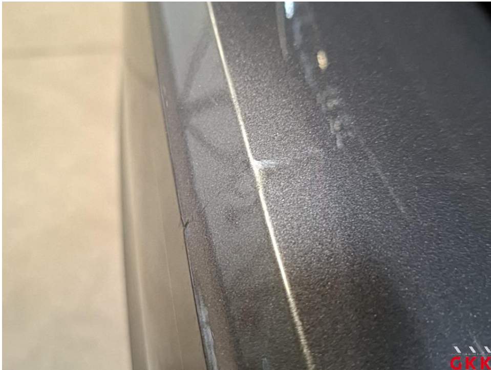
Bild 26 Stoßfänger hinten, Verkleidung -lackiert-, beschädigt, ersetzen
