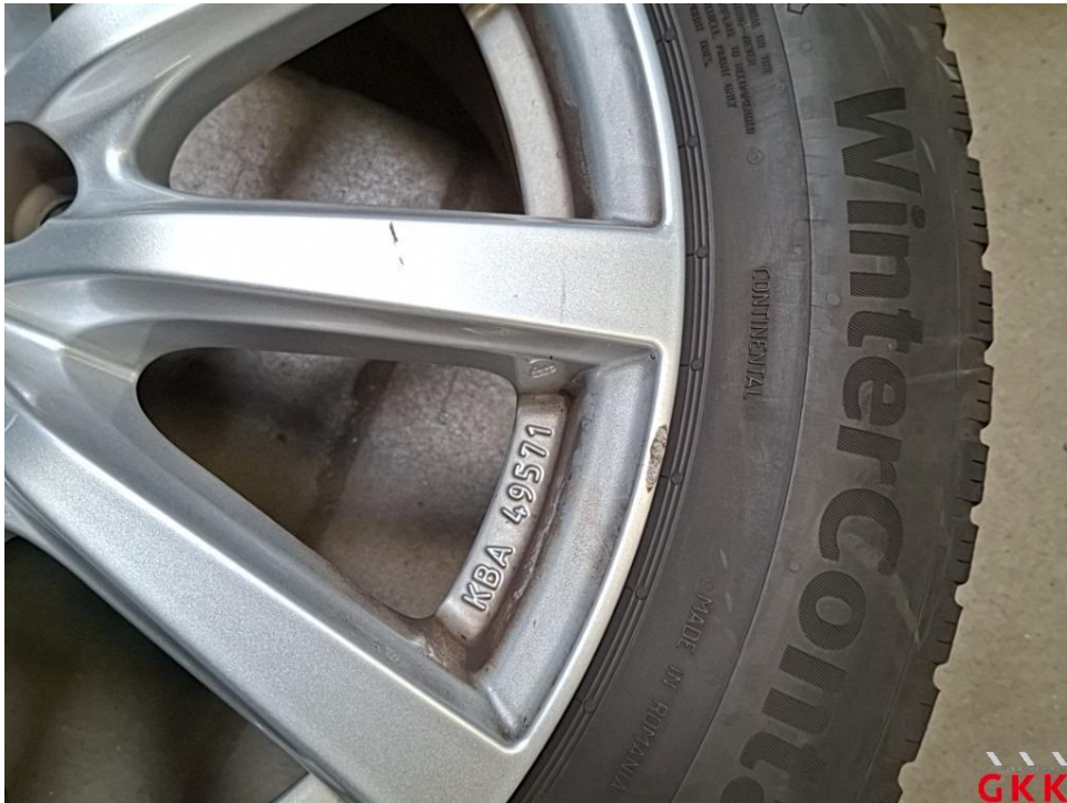
Bild 22 LM-Rad, 1 x beiliegend, Materialabtrag, ersetzen
