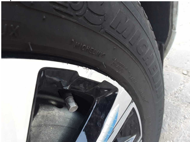
Beschädigung #2: Rad/Reifen: Leichtmetallfelge vorn rechts - Kratzer - erneuern
