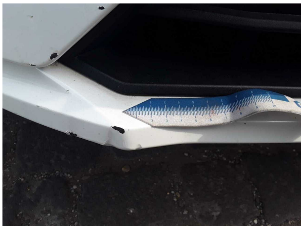
Beschädigung #4: Stossfänger vorn: Stossfänger vorn - Kratzer - lackieren
