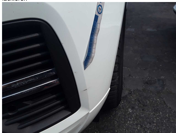
Beschädigung #4: Stossfänger vorn: Stossfänger vorn - Kratzer - lackieren
