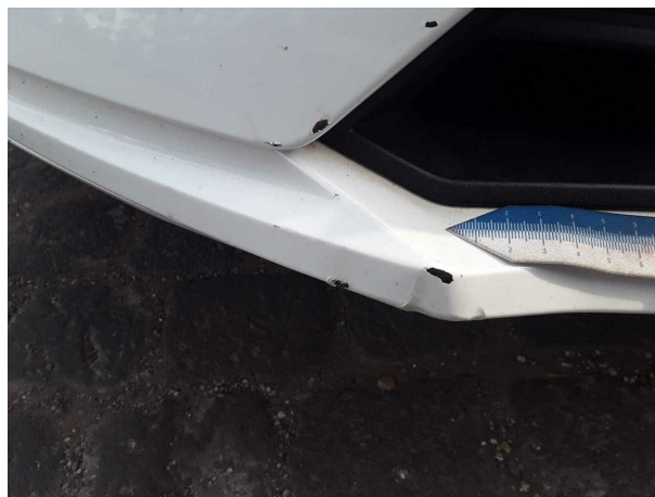
Beschädigung #4: Stossfänger vorn: Stossfänger vorn - Kratzer - lackieren
