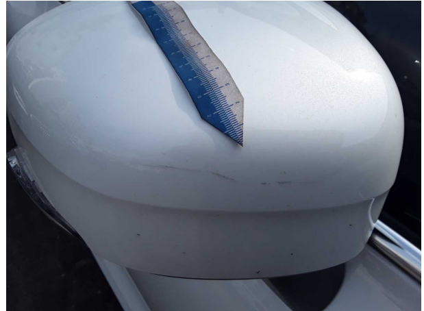
Beschädigung #1: Außenspiegel links: Abdeckkappe - Kratzer - Smart Repair
