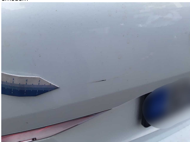
Beschädigung #3: Heckklappe/-tür: Heckklappe - Kratzer - lackieren
