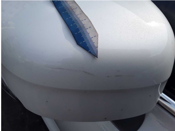
Beschädigung #1: Außenspiegel links: Abdeckkappe - Kratzer - Smart Repair
