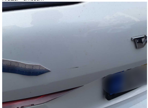
Beschädigung #3: Heckklappe/-tür: Heckklappe - Kratzer - lackieren
