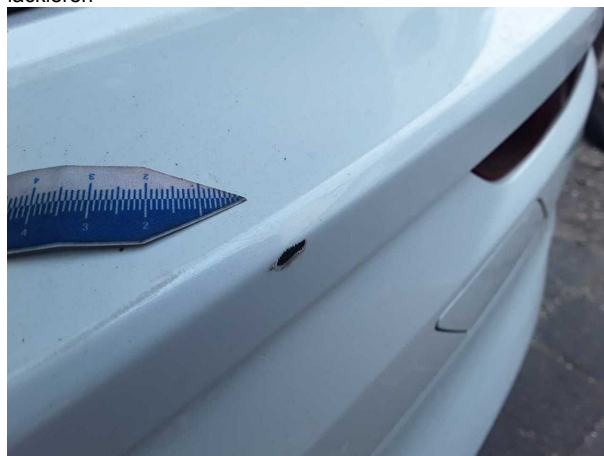
Beschädigung #5: Stossfänger hinten: Stossfänger hinten (+ Spoiler lackieren) - Kratzer - lackieren
