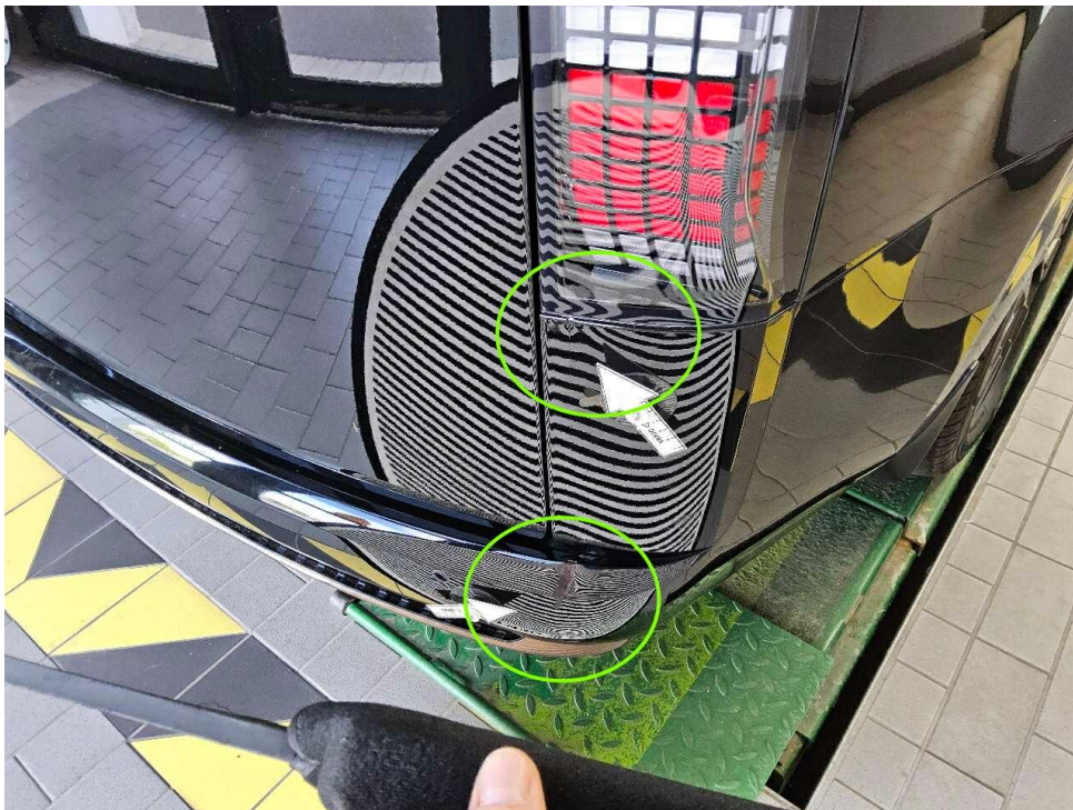
Bild 16 : Stoßfänger hinten, Rücklichtblende unten rechts, deformiert, Rücklicht rechts, zerkratzt
