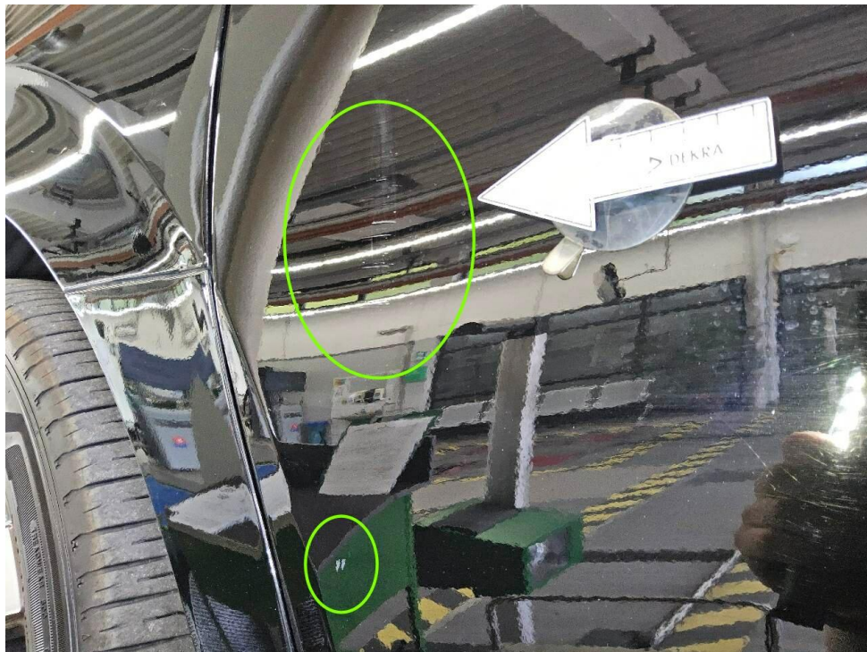
Bild 12 : Tür vorne links Lackierung, zerkratzt
