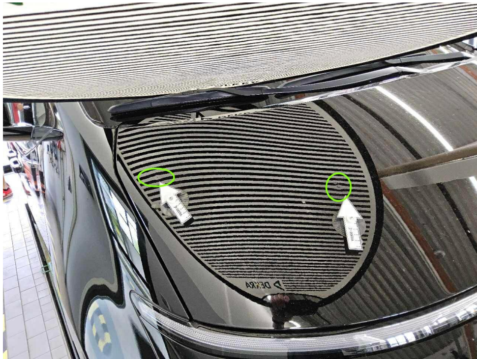
Bild 9 : Motorhaube, mehrfach eingedellt, mit Lackstift ausgebessert
