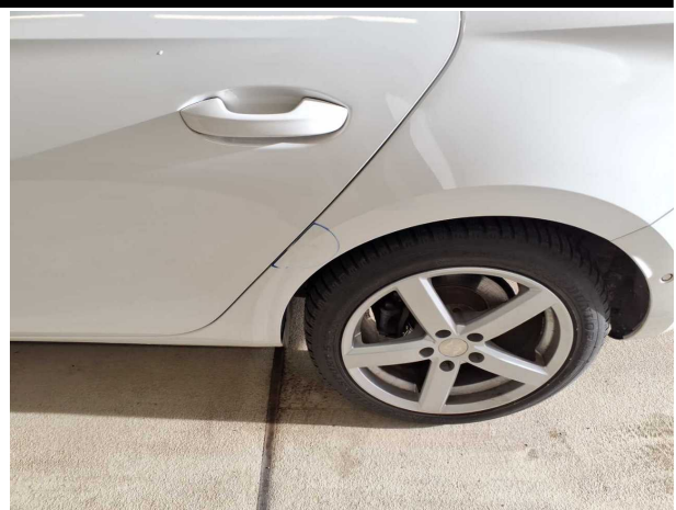
Beschädigung #7: Seitenwand links: Seitenwand - Delle(n) - sanft instandsetzen
