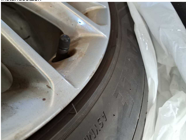
Beschädigung #9: 2.Radsatz: 1 Leichtmetallfelge - verkratzt / verschürft - Wertminderung
