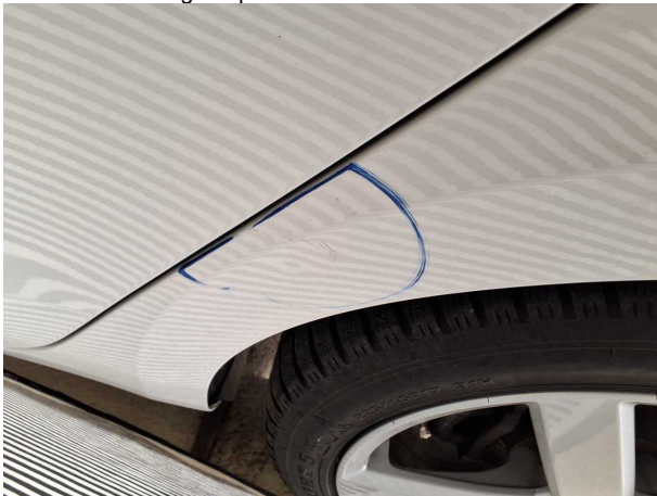
Beschädigung #7: Seitenwand links: Seitenwand - Delle(n) - sanft instandsetzen
