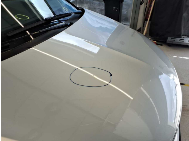
Beschädigung #1: Motorhaube: Motorhaube - Delle(n) - Smart Repair
