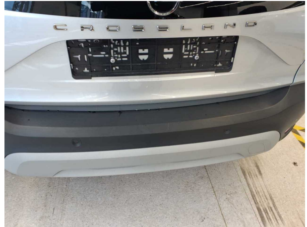
Beschädigung #5: Stossfänger hinten: Stossfänger hinten - Kratzer - Wertminderung
