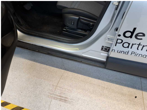
Beschädigung #2: Schweller links: Einstieg - Kratzer - Smart Repair
