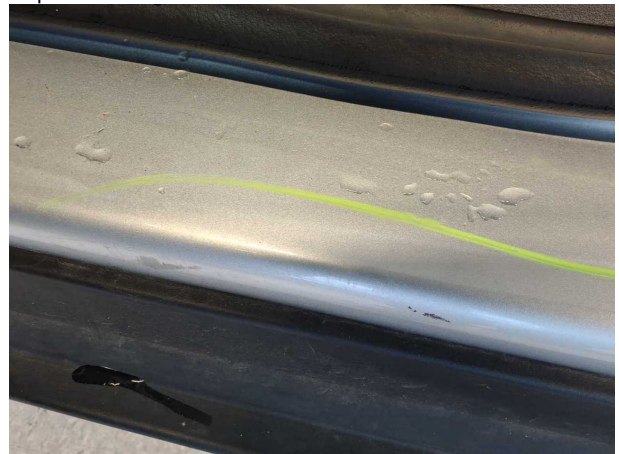
Beschädigung #2: Schweller links: Einstieg - Kratzer - Smart Repair
