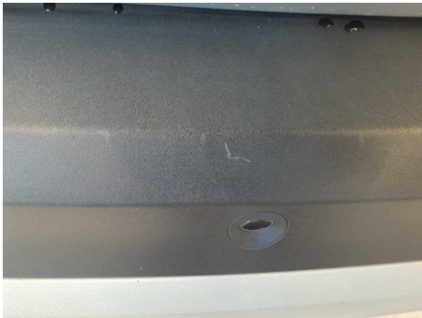
Beschädigung #5: Stossfänger hinten: Stossfänger hinten - Kratzer - Wertminderung
