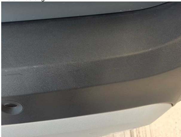
Beschädigung #5: Stossfänger hinten: Stossfänger hinten - Kratzer - Wertminderung
