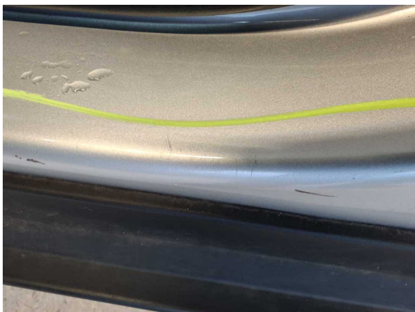
Beschädigung #2: Schweller links: Einstieg - Kratzer - Smart Repair
