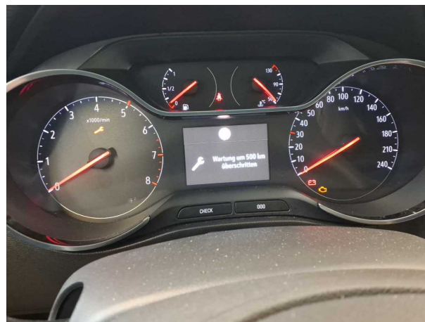
Beschädigung #6: Sonstiges: Inspektion/Wartung - fällig - durchführen
