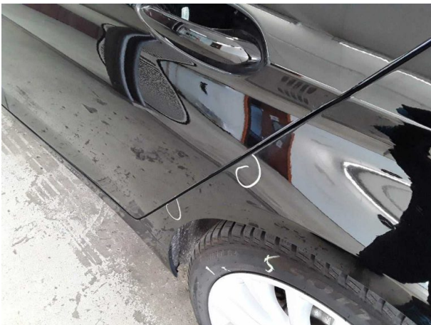
Beschädigung #9: Seitenwand links: Seitenwand - Delle(n) - sanft instandsetzen
