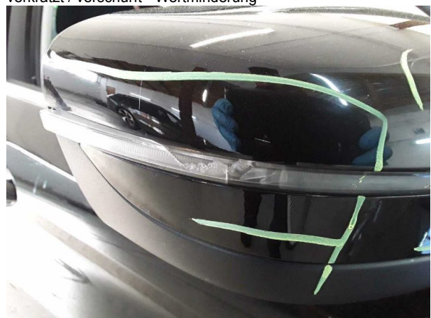
Beschädigung #7: Blinkleuchte: Spiegel rechts - beschädigt - erneuern
