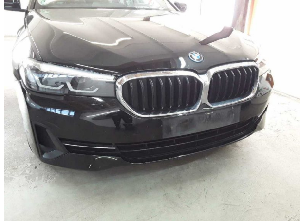
Beschädigung #6: Stossfänger vorn: Stossfänger vorn - verkratzt / verschürft - Wertminderung
