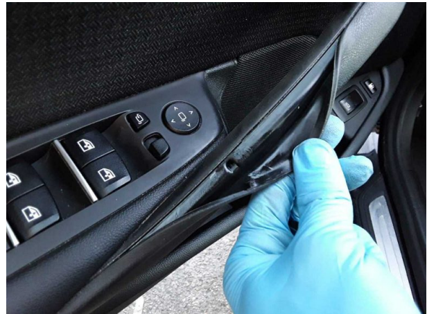
Beschädigung #8: Tür vorn links: Griff innen - lose - de-/montieren
