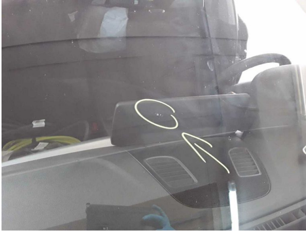
Beschädigung #11: Verglasung: Frontscheibe (Rissbildung) - Steinschlag - erneuern
