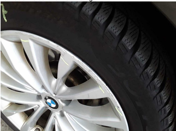
Beschädigung #4: Rad/Reifen: Leichtmetallfelge vorn links - verkratzt / verschürft - kein Abzug
