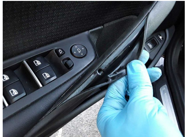
Damage #8: Door - front left side: Door handle - inside - Loose - Un- / install
