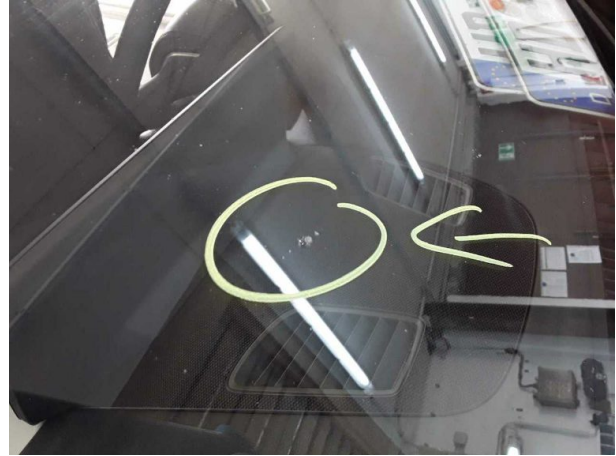
Beschädigung #11: Verglasung: Frontscheibe (Rissbildung) - Steinschlag - erneuern
