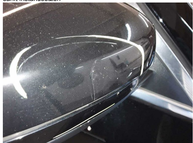
Beschädigung #10: Außenspiegel rechts: Abdeckkappe (Gebrochen) - beschädigt - erneuern
