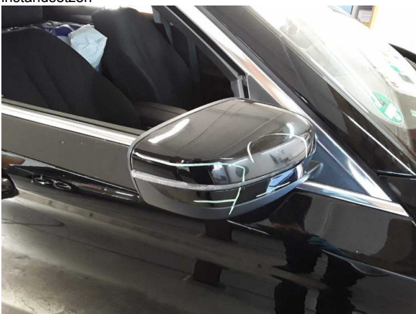
Beschädigung #10: Außenspiegel rechts: Abdeckkappe (Gebrochen) - beschädigt - erneuern
