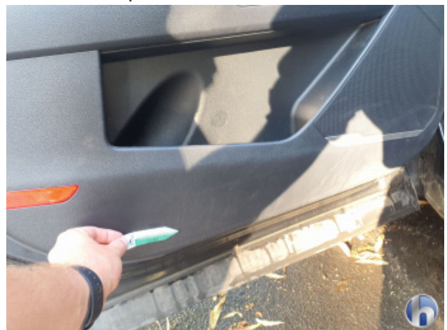
4. Verkleidung Kratzer - Erneuern
