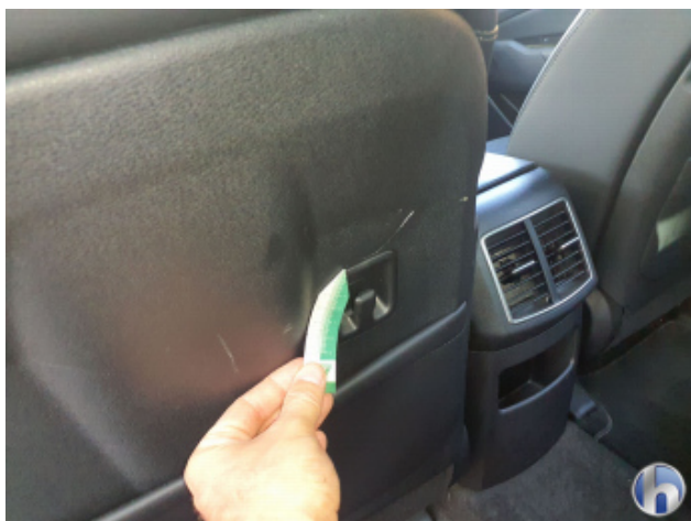
5. Sitz Innenraum links vorne Kratzer - Erneuern
