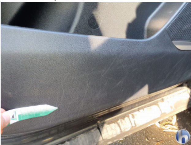
4. Verkleidung Kratzer - Erneuern
