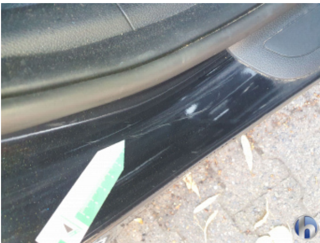
3. Schweller - Rechts Kratzer - Smart Repair
