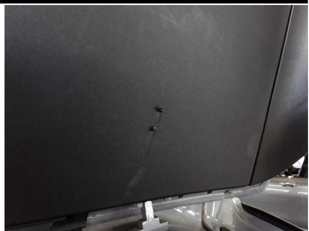
Beschädigung #13: Verkleidungen/Abdeckungen: Heckdeck... Innenverkleidung - verkratzt / verschürft - erneuern
