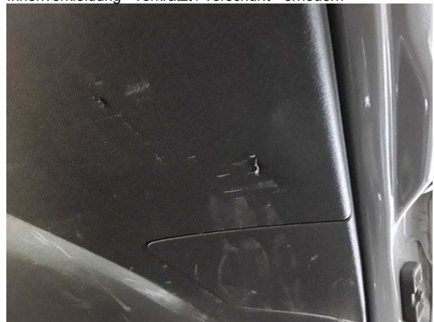
Beschädigung #13: Verkleidungen/Abdeckungen: Heckdeck... Innenverkleidung - verkratzt / verschürft - erneuern
