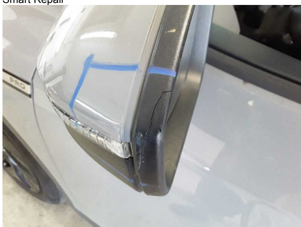
Beschädigung #17: Außenspiegel links: Spiegelgehäuse - gebrochen / gerissen - erneuern
