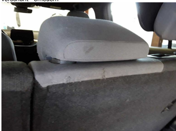
Beschädigung #8: Sitz hinten: Rücksitz - porös / rissig - Wertminderung
