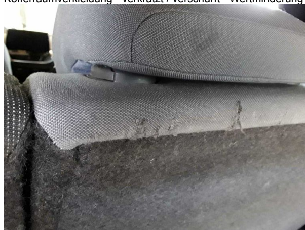
Beschädigung #8: Sitz hinten: Rücksitz - porös / rissig - Wertminderung
