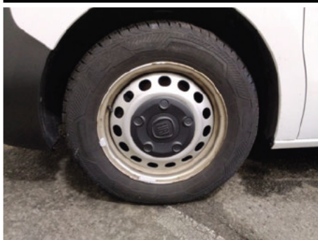
Felge / Vorne Links / Rost
