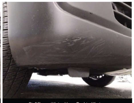
Stoßfänger / Unten Vorne Rechts / Kratzer
