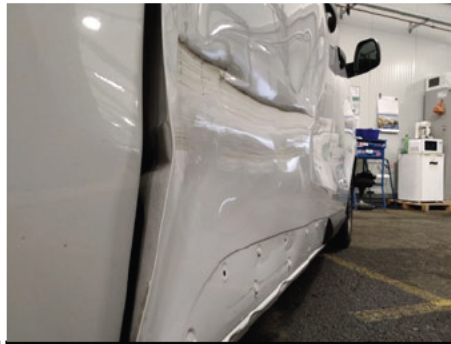
Tür / Rechts / Delle
