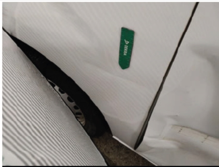
Seitenwand / Hinten Rechts / Delle
