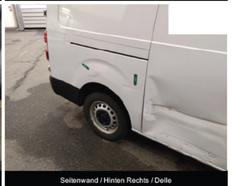
Seitenwand / Hinten Rechts / Delle
