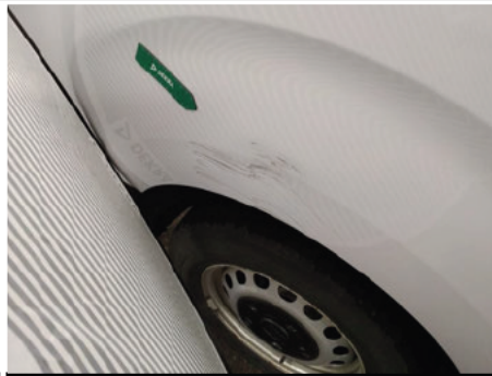
Seitenwand / Hinten Rechts / Delle
