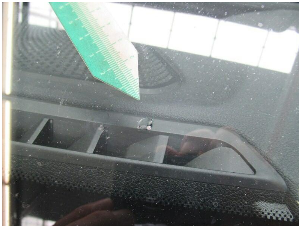
Bild 17 : - T - Frontscheibe Steinschlag
