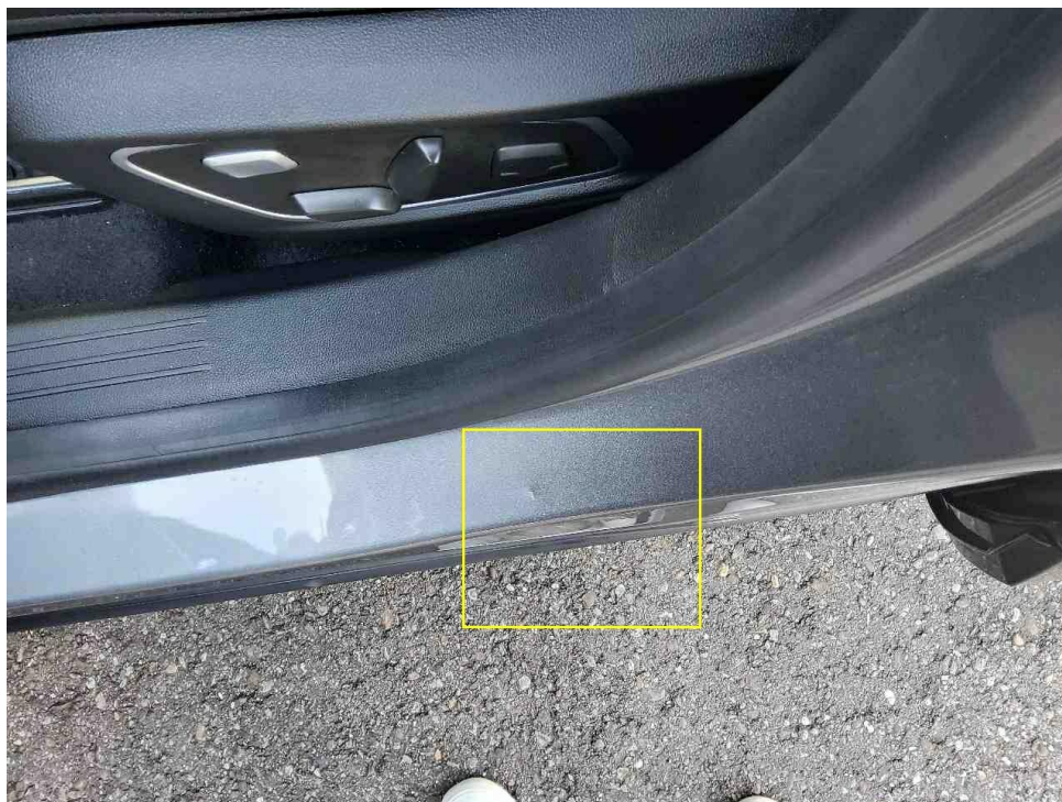
Bild 5 : Einstieg vorne links Delle mit Kratzer
