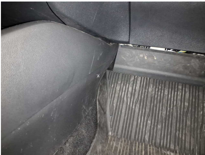
Damage 8: Instrument panel: Centre console - front (Verkleidung rechts, Fehlbohrungen) - Differs from the original configuration - Replace
