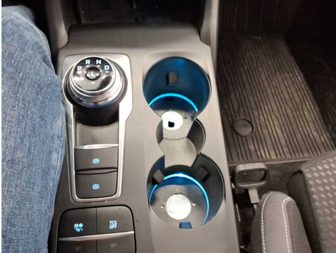
Damage 11: Instrument panel: Centre console - front (Getränkehalter, Fehlbohrungen) - Differs from the original configuration - Replace
