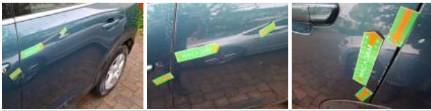
Door FL, Scratch(es), Paint
