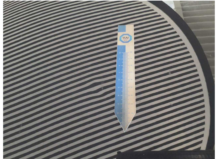
Damage 3: Bonnet: Bonnet (Zusätzlich Steinschläge) - dent(s) - Smooth repair work
