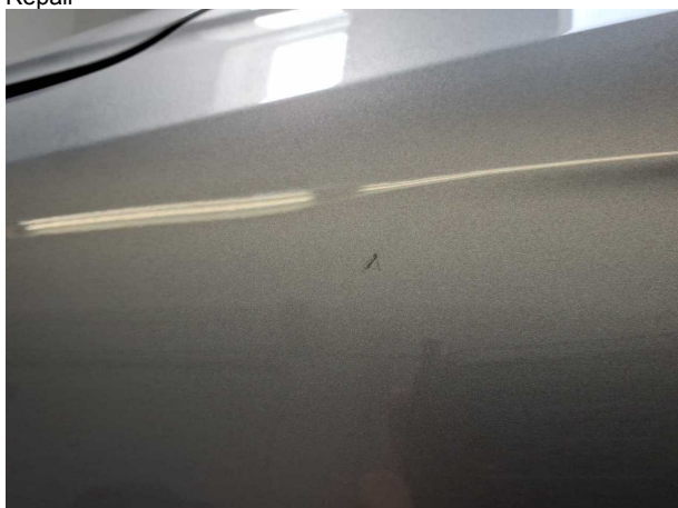
Beschädigung #6: Kotflügel links: Kotflügel links - Kratzer - lackieren
