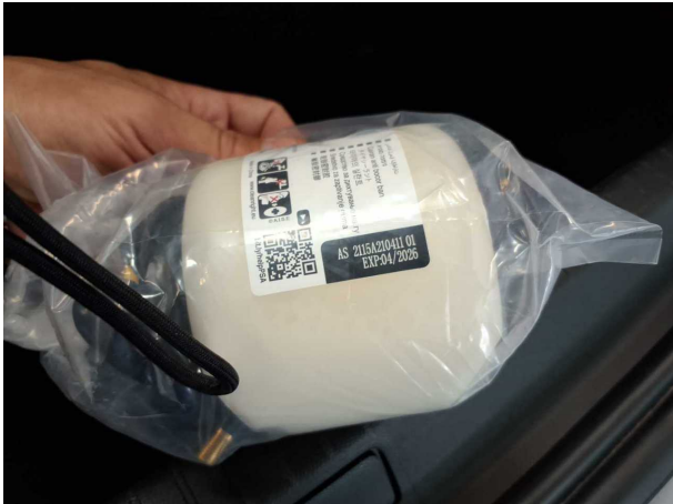
Beschädigung #2: Ausrüstung: Tirefit Füllmittel - abgelaufen - erneuern
