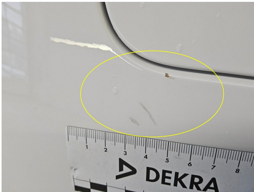
Bild 23 : Seitenteil hinten rechts Lackierung, zerkratzt, smart repair
