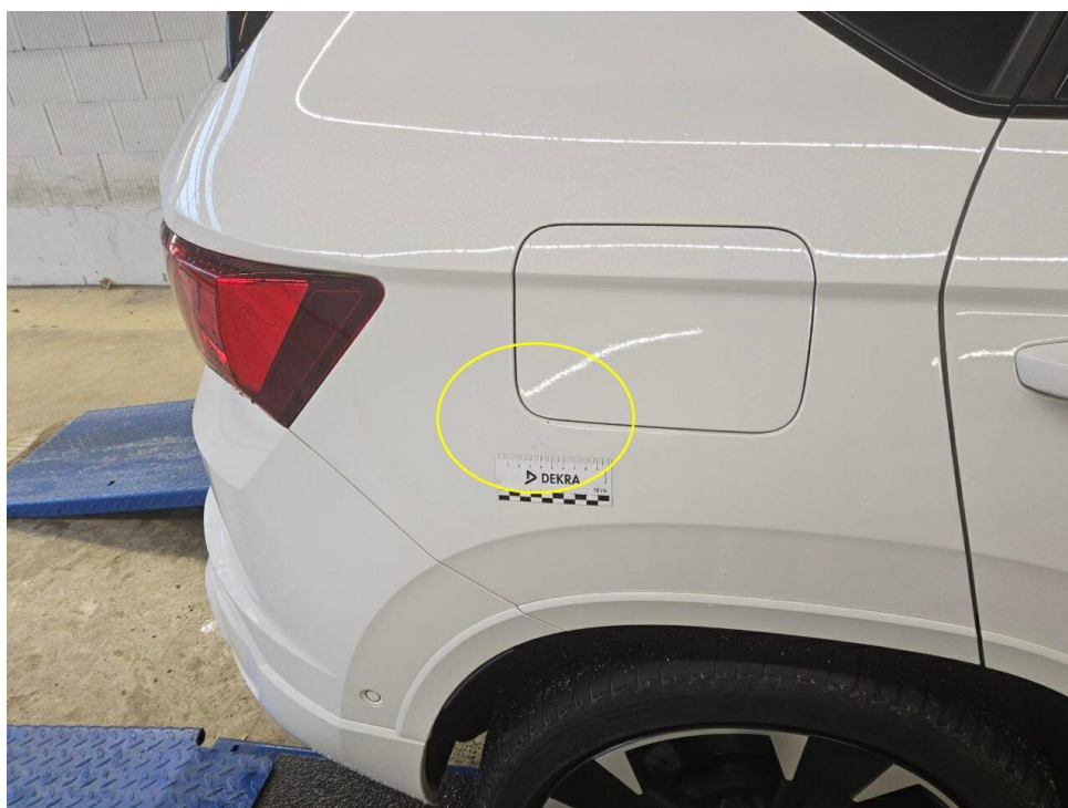
Bild 22 : Seitenteil hinten rechts Lackierung, zerkratzt, smart repair
