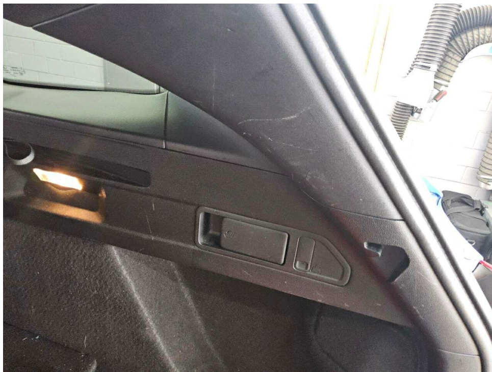
Bild 22 : Kofferraum Seitenverkleidung rechts, zerkratzt
