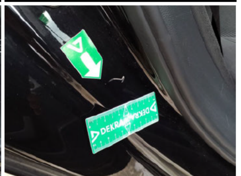
Entrée de porte / Arrière Droit / Rayure
