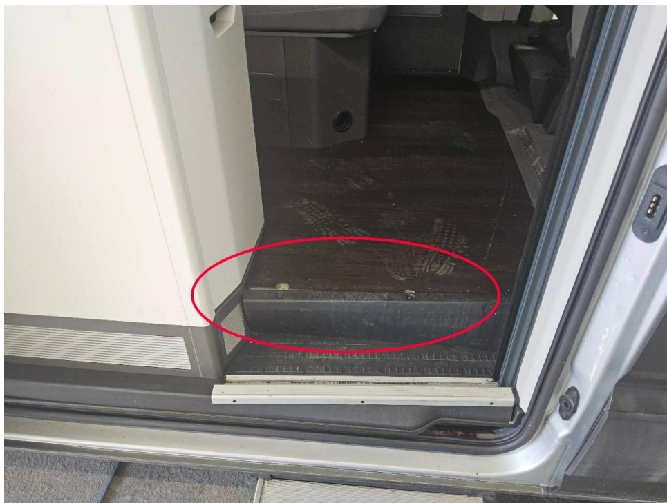
Bild 13 : Schaden Einstieg Schiebetür
