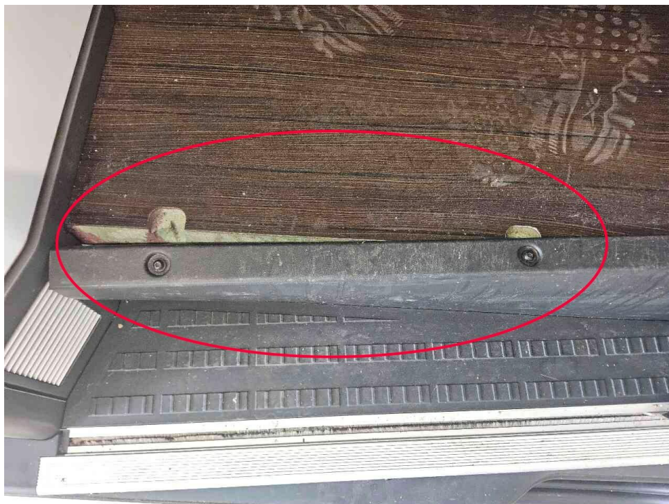
Bild 14 : Schaden Einstieg Schiebetür
