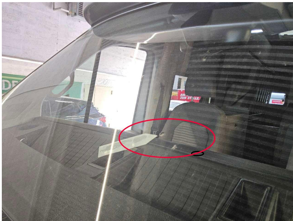
Bild 17 : Frontscheibe Steinschlag mit Rissbildung
