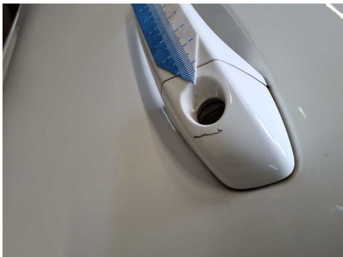
Damage 2: Door - front left side: Door handle - outside (Schlossabdeckung) - Scratch(es) - Smart repair
