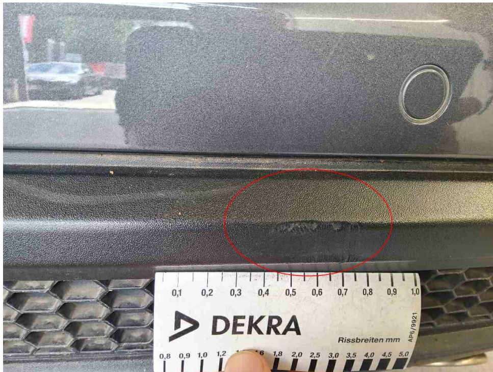
Bild 25 : Schaden Stoßfänger hinten rechts
