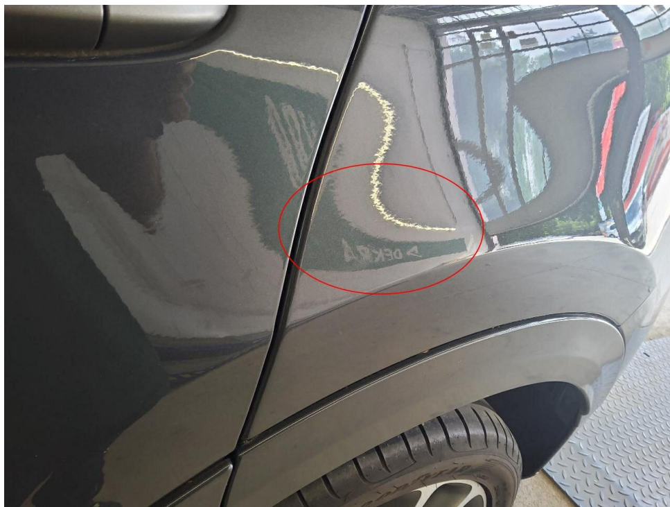
Bild 26 : Seitenteil hinten links, Lackierung, zerkratzt
