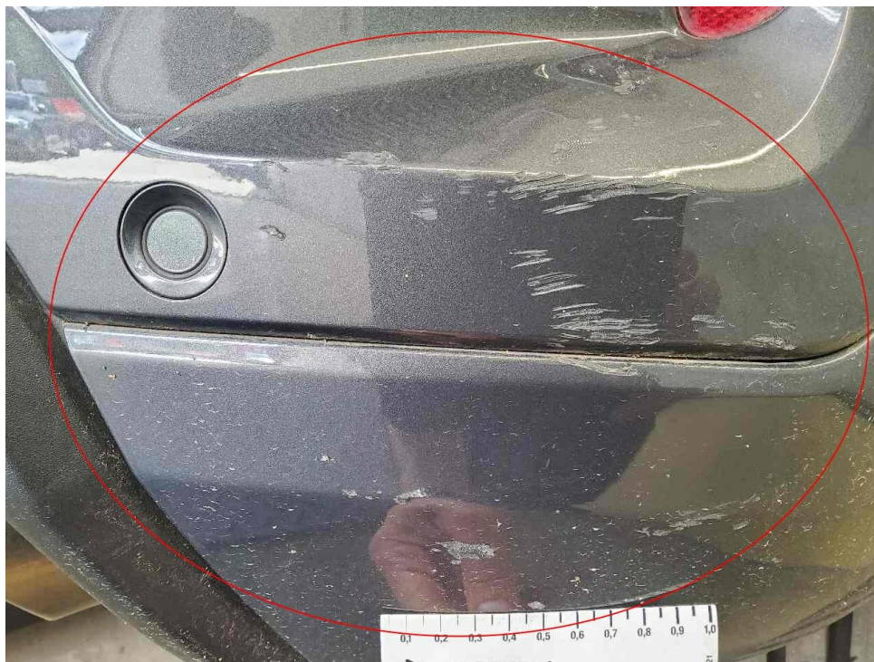
Bild 22 : Schaden Stoßfänger hinten rechts
