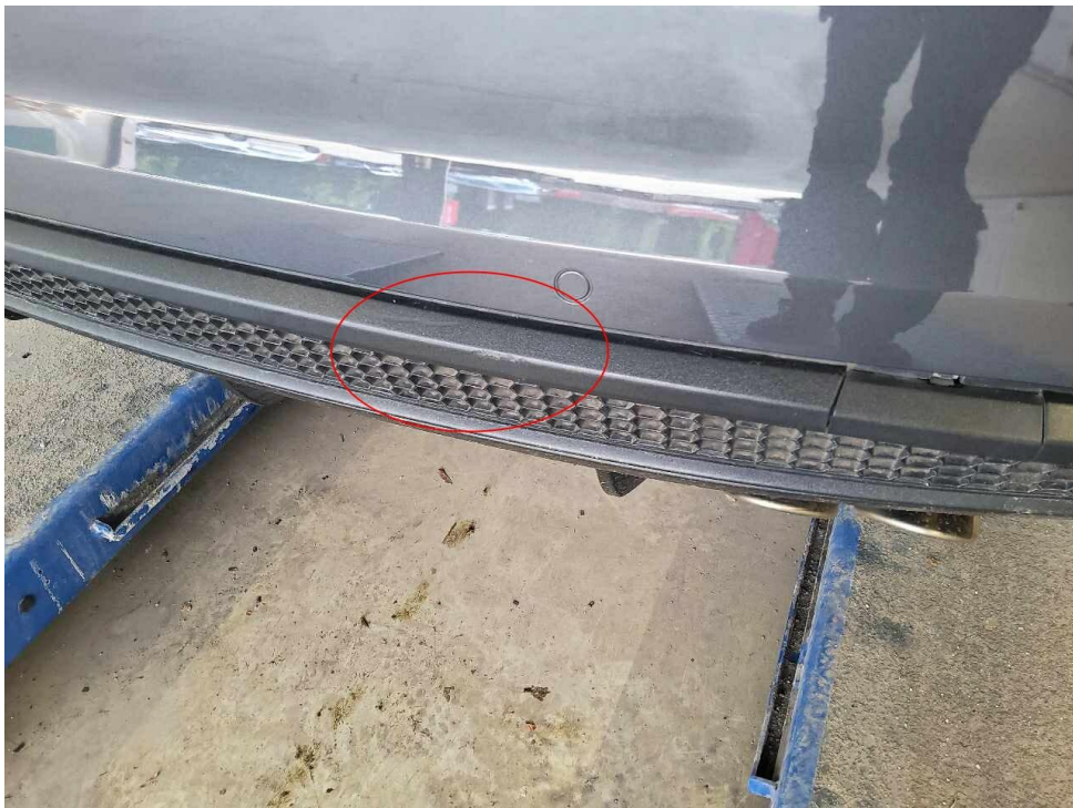
Bild 24 : Schaden Stoßfänger hinten rechts
