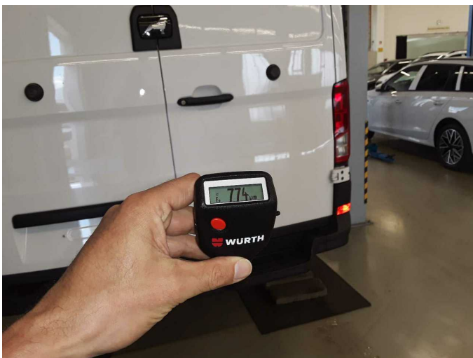
Boot lid / rear door: 774 µm
