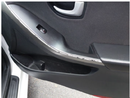
Türverkleidung / Vorne Rechts / Verschlissen
