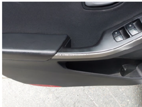
Türverkleidung / Vorne Links / Verschlissen
