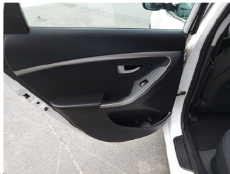
Türverkleidung / Hinten Links / Verschlissen
