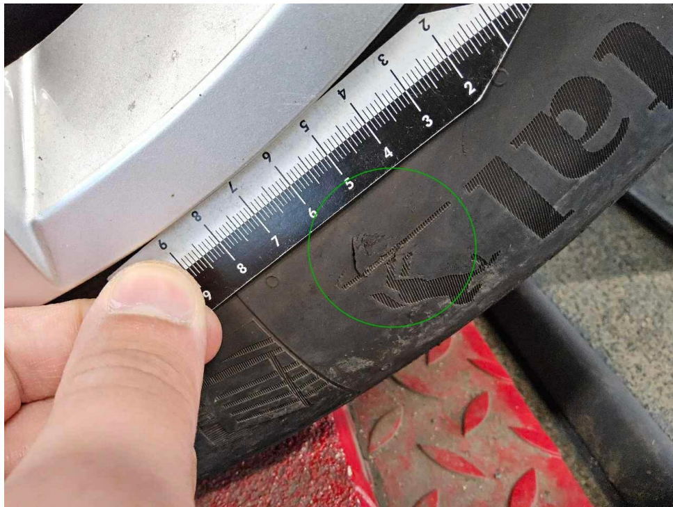
Bild 18 : Reifen 1.Achse Rissbildung und Verschleißgrenze unter 4mm
