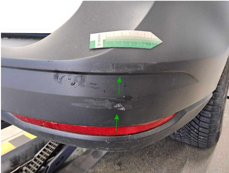
Bild 20 : Heckstoßfänger hinten verschrammt
