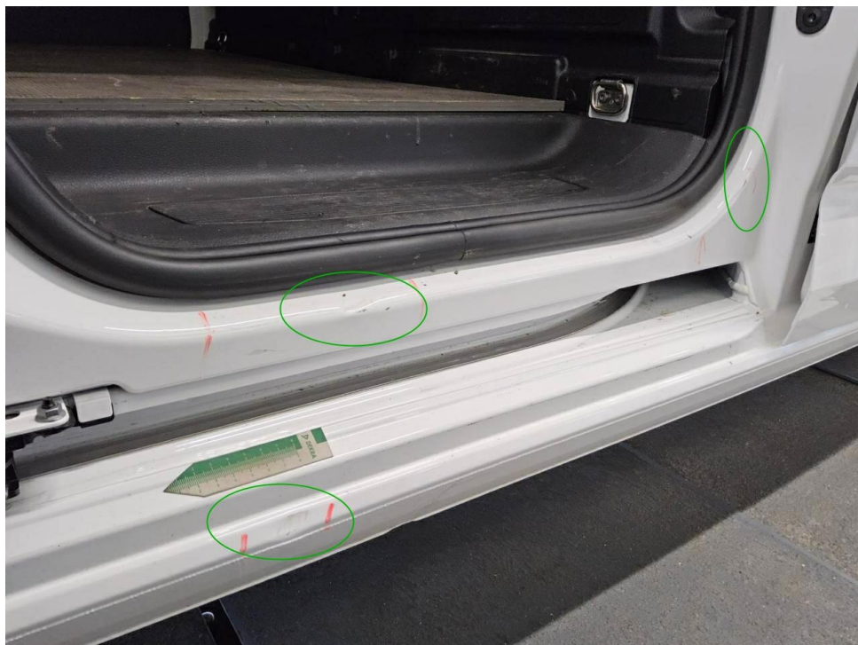
Bild 15 : Seitenschweller rechts, eingedellt, instandsetzen und lackieren mit Lackaufbau
