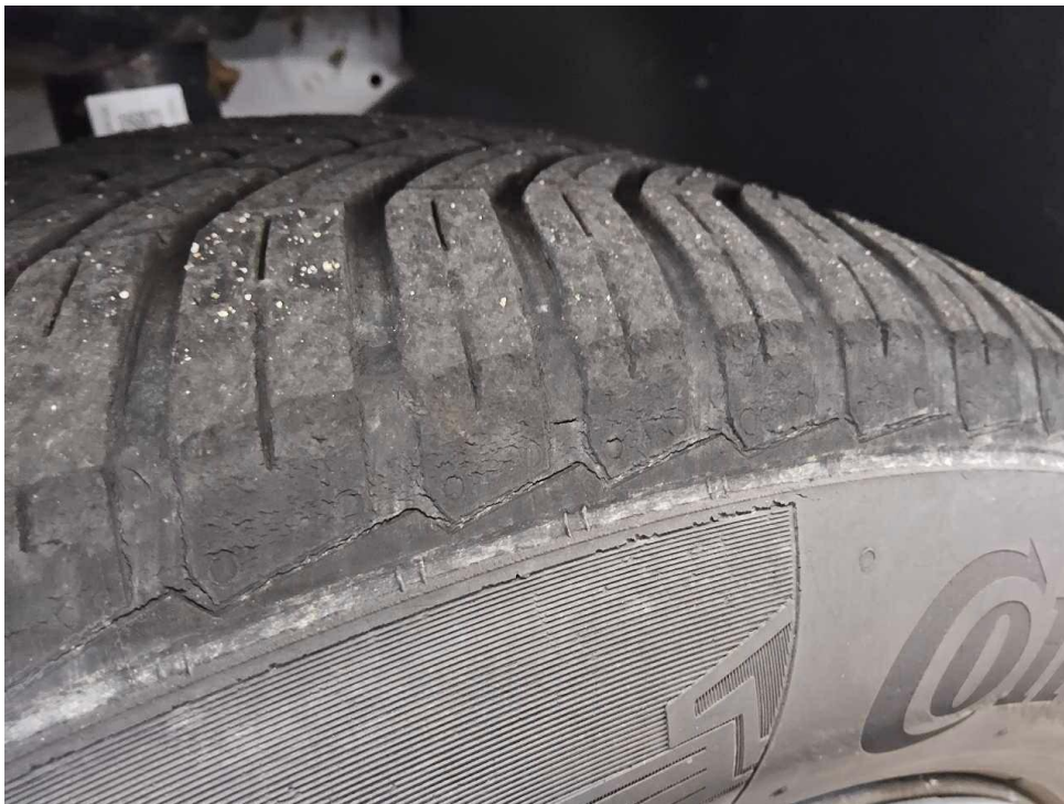
Bild 17 : Reifen 1.Achse Rissbildung und Verschleißgrenze unter 4mm
