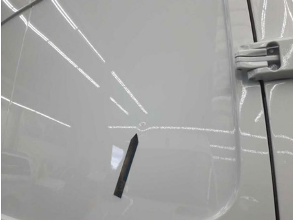
Beschädigung #1: Heckklappe/-tür: Hecktür rechts - Delle(n) - Smart Repair
