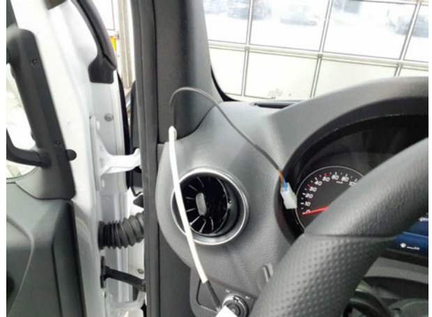
Beschädigung #2: elektrisches System: Kabelstrang - abweiche... Auslieferungszustand - de-/montieren
