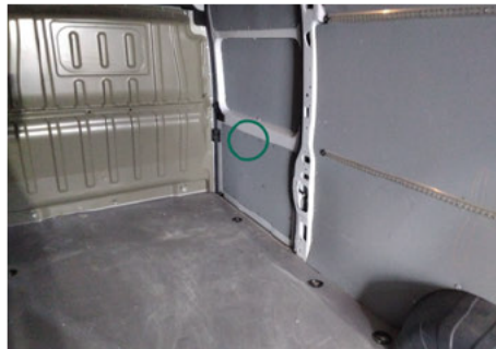
Innenverkleidung Laderaum / Unten Vorne Rechts / Gebrochen
