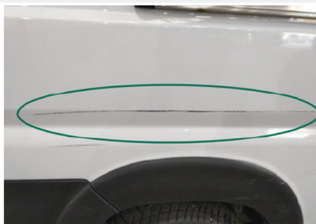
Seitenwand / Unten Hinten Rechts / Schlecht Repariert
