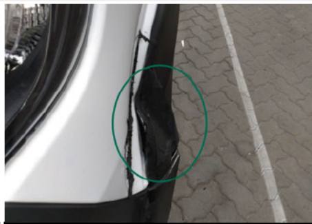
Kotflügelzierleiste / Vorne Links / Delle
