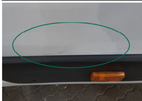
Seitenwand / Unten Hinten Rechts / Schlecht Repariert
