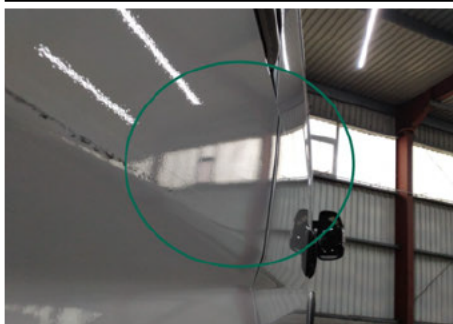
Seitenwand / Unten Hinten Rechts / Schlecht Repariert
