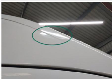
Dachholm / Vorne Rechts / Kratzer
