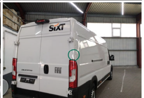
Säule / Hinten Rechts / Delle
