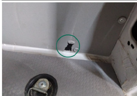
Innenverkleidung Laderaum / Rechts / Gebrochen
