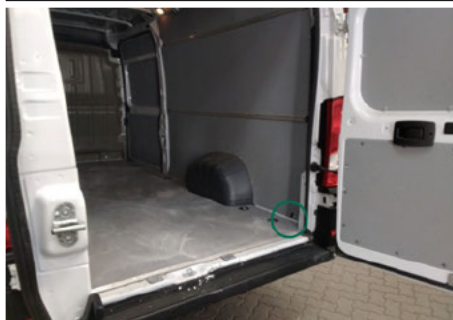
Innenverkleidung Laderaum / Rechts / Gebrochen
