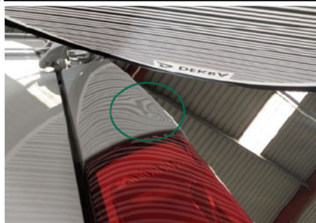
Säule / Hinten Rechts / Delle
