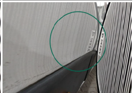
Seitenwand / Unten Hinten Rechts / Schlecht Repariert
