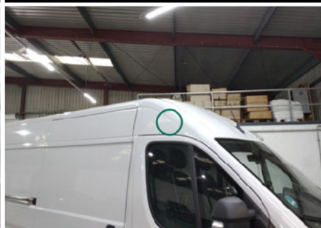
Dachholm / Vorne Rechts / Kratzer
