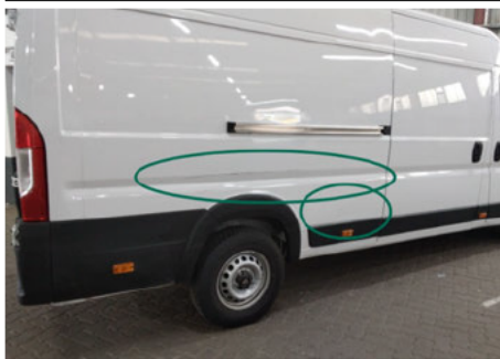
Seitenwand / Unten Hinten Rechts / Schlecht Repariert
