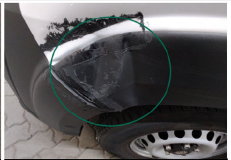
Kotflügelzierleiste / Vorne Links / Delle
