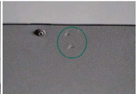
Innenverkleidung Laderaum / Unten Vorne Rechts / Gebrochen
