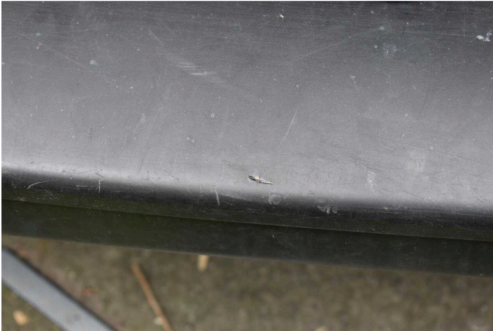
Bild 21 Fahrzeugheck Stoßfänger hinten Kratzer
