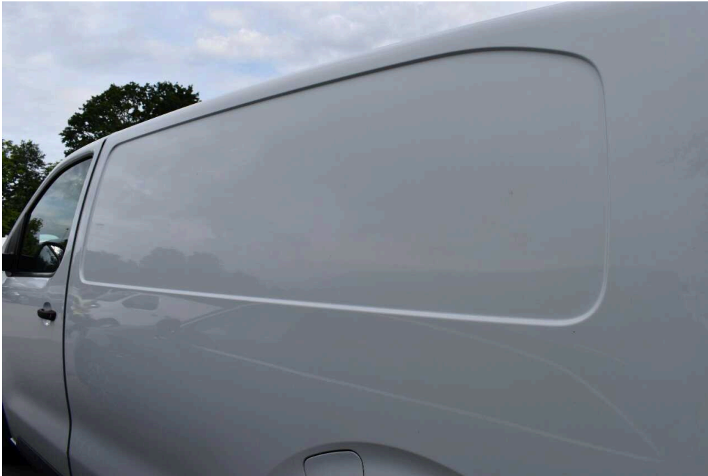
Bild 17 linke Seite Seitenwand links Dellen
