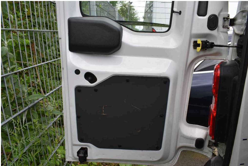
Bild 15 Innenraum Heckflügeltürverkleidung links gebrochen
