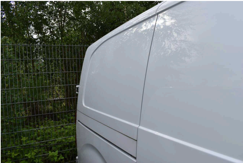
Bild 22 rechte Seite Seitenteil hinten rechts Dellen
