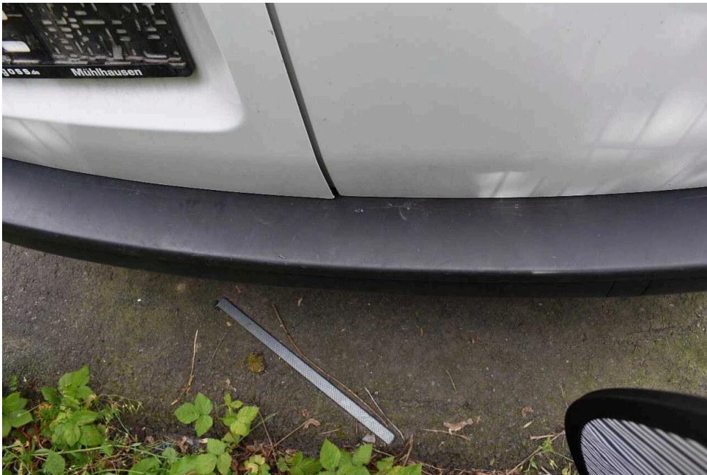
Bild 20 Fahrzeugheck Stoßfänger hinten Kratzer
