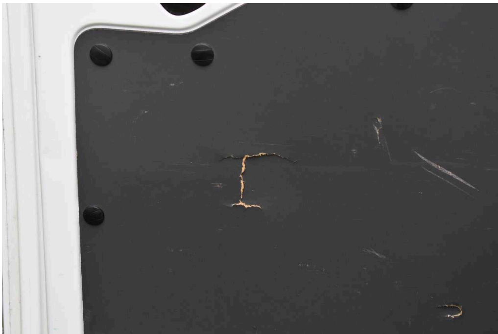
Bild 16 Innenraum Heckflügeltürverkleidung links gebrochen
