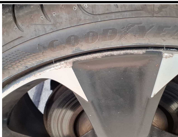
Beschädigung #6: Rad/Reifen: Leichtmetallfelge hinten rechts - verkratzt / verschürft - Wertminderung
