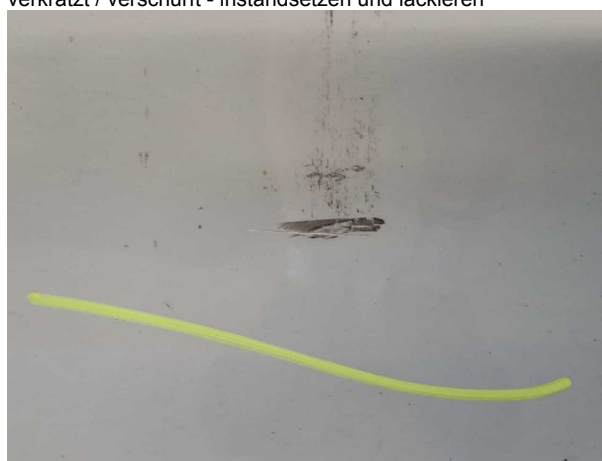
Beschädigung #8: Tür hinten rechts: Tür - verkratzt / versch... - instandsetzen und lackieren
