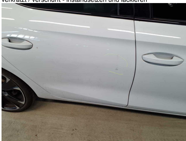
Beschädigung #8: Tür hinten rechts: Tür - verkratzt / verschürft - instandsetzen und lackieren
