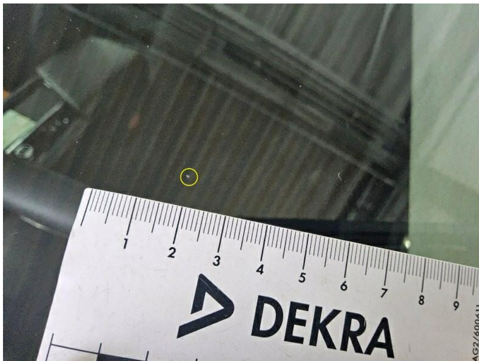
Bild 14 : Windschutzscheibe - vereinzelte Oberflächensteinschläge (Gebrauchsspur)
