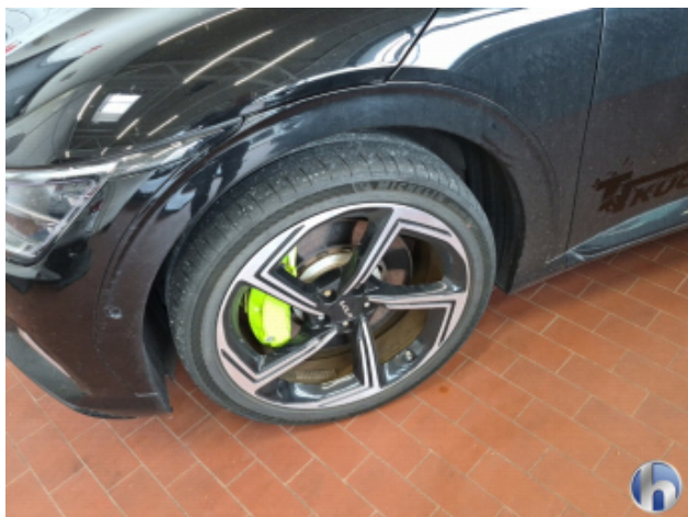
3. Reifen Vorne - Links Verschlissen - Erneuern
