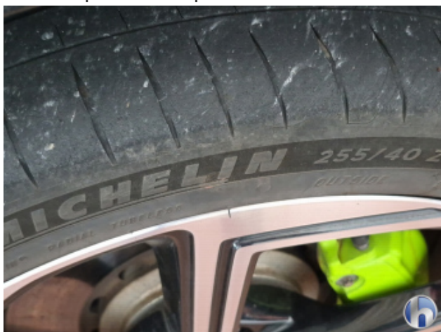
2. Reifen Vorne - Rechts Verschlissen - Erneuern
