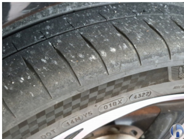
3. Reifen Vorne - Links Verschlissen - Erneuern
