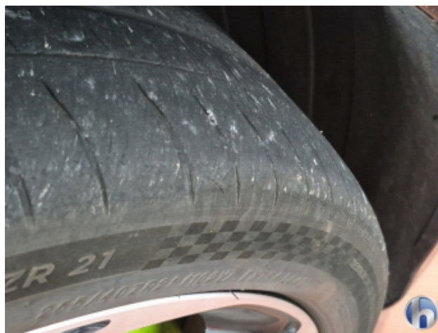
2. Reifen Vorne - Rechts Verschlissen - Erneuern
