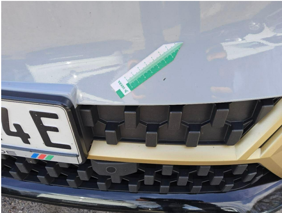
Bild 11 : Stoßfänger vorne Lackierung, Steinschlag, smart repair
