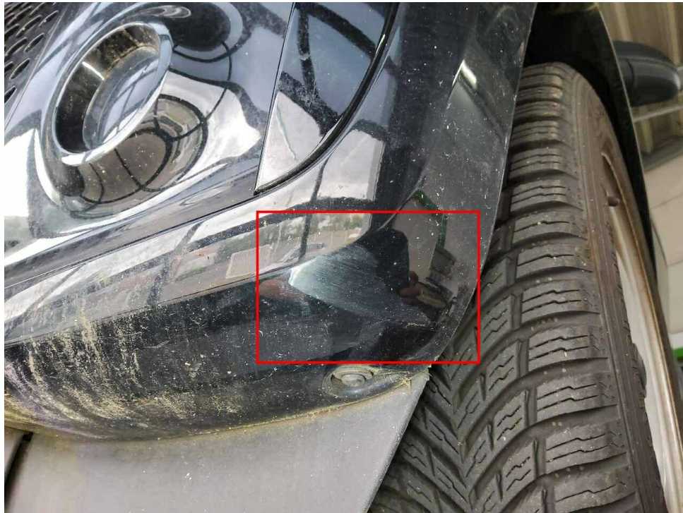
Bild 13 : Stoßfänger vorne Lackierung, verschrammt, lackieren mit Lackaufbau
