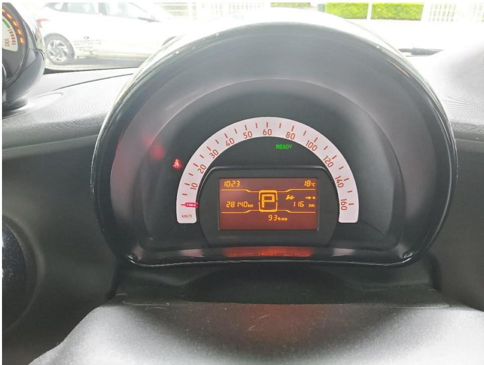
Bild 6 : Kombiinstrument (betriebsbereit) mit Km-Stand
