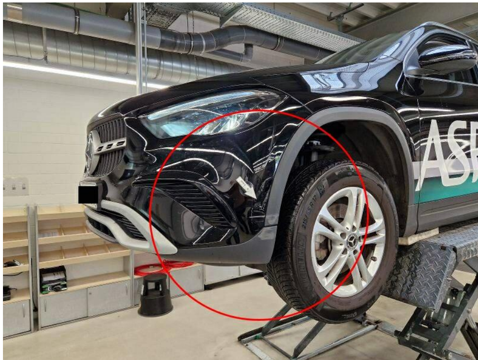
Bild 15 : Frontschaden links (Stoßfänger vorne/ Spoiler vorne links/ Radlaufverkleidung VA links verschrammt)
