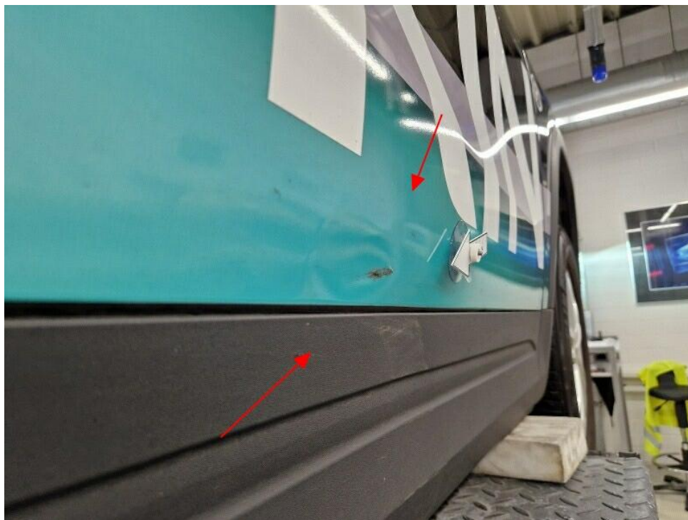
Bild 23 : Tür vorne rechts unten eingedrückt/ Stoßleiste verschrammt
