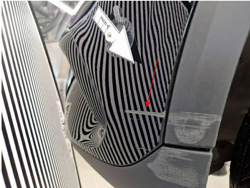
Bild 17 : Frontschaden links (Stoßfänger vorne/ Spoiler vorne links/ Radlaufverkleidung VA links verschrammt)
