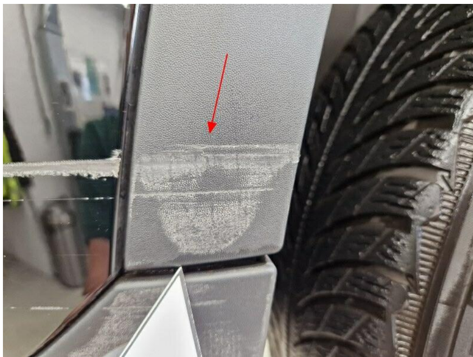
Bild 18 : Frontschaden links (Stoßfänger vorne/ Spoiler vorne links/ Radlaufverkleidung VA links verschrammt)
