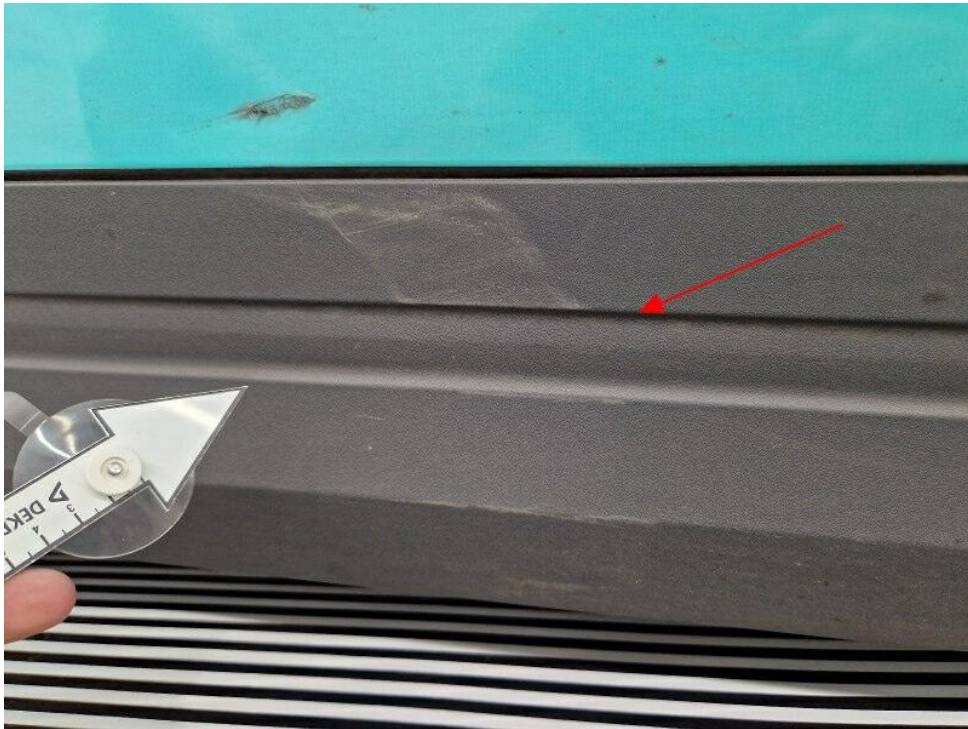
Bild 25 : Tür vorne rechts unten eingedrückt/ Stoßleiste verschrammt
