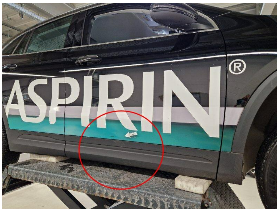
Bild 20 : Tür vorne rechts unten eingedrückt/ Stoßleiste verschrammt
