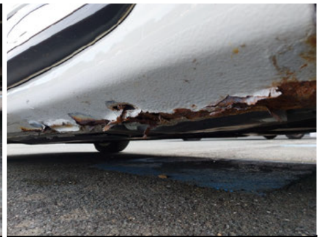
Schweller / Links / Rost
