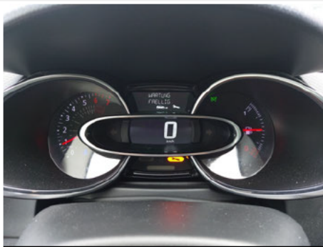
Warnleuchte Inspektion / Fehlt
