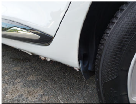
Schweller / Links / Rost
