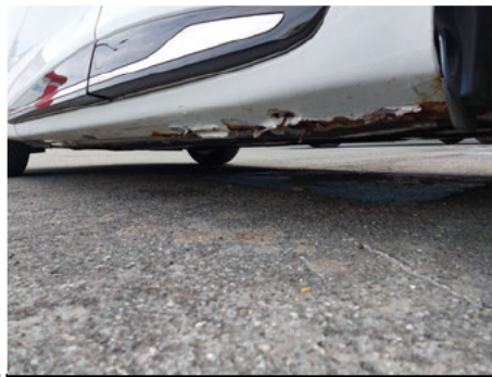
Schweller / Links / Rost
