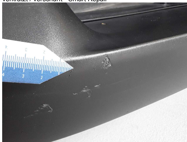
Beschädigung #3: Stossfänger vorn: Spoiler - Kratzer - Smart Repair
