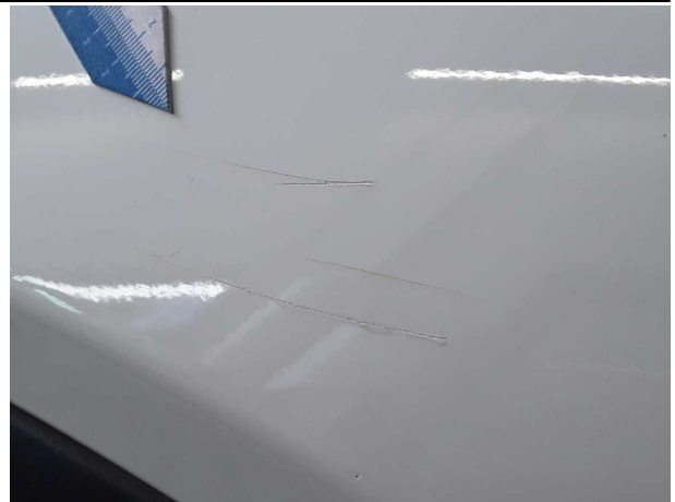
Beschädigung #4: Kotflügel links: Kotflügel links - nicht fachgerecht instandgesetzt - lackieren
