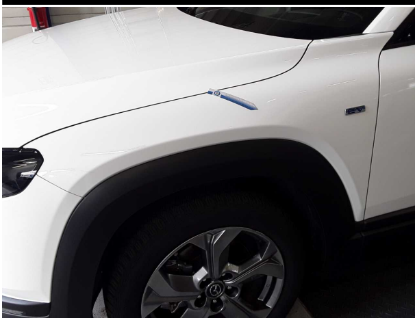
Beschädigung #4: Kotflügel links: Kotflügel links - nicht fachgerecht instandgesetzt - lackieren
