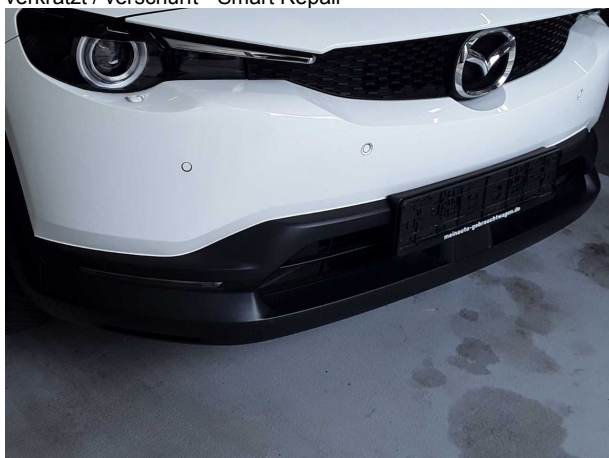
Beschädigung #3: Stossfänger vorn: Spoiler - Kratzer - Smart Repair
