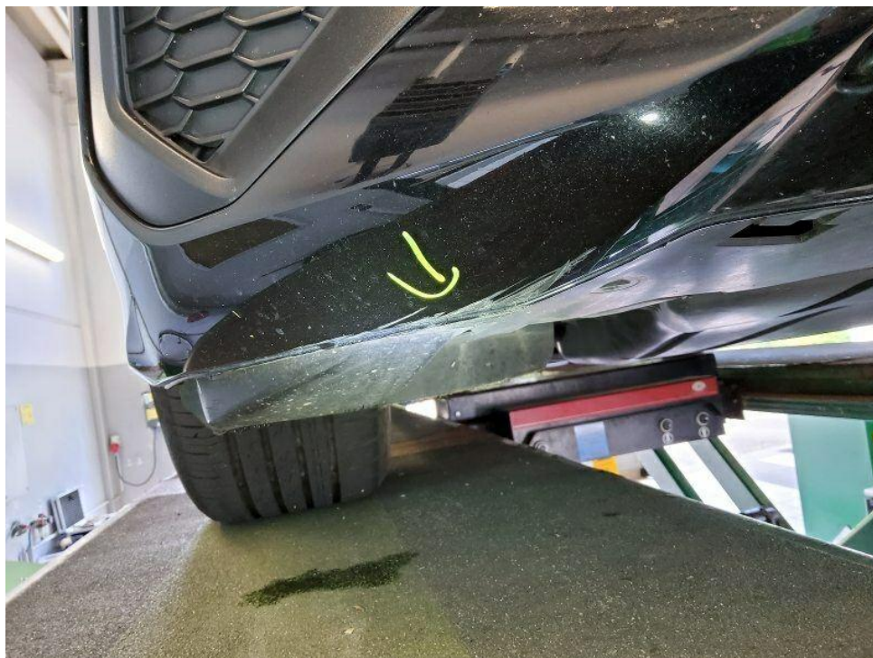
Bild 42 : Frontstoßfängerverkleidung verschrammt bis Grundierung
