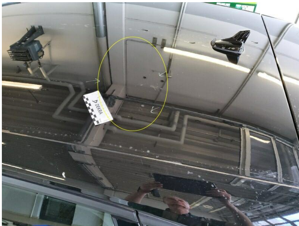
Bild 17 : Dach mehrere oberflächige Kratzer an diversen Stellen
