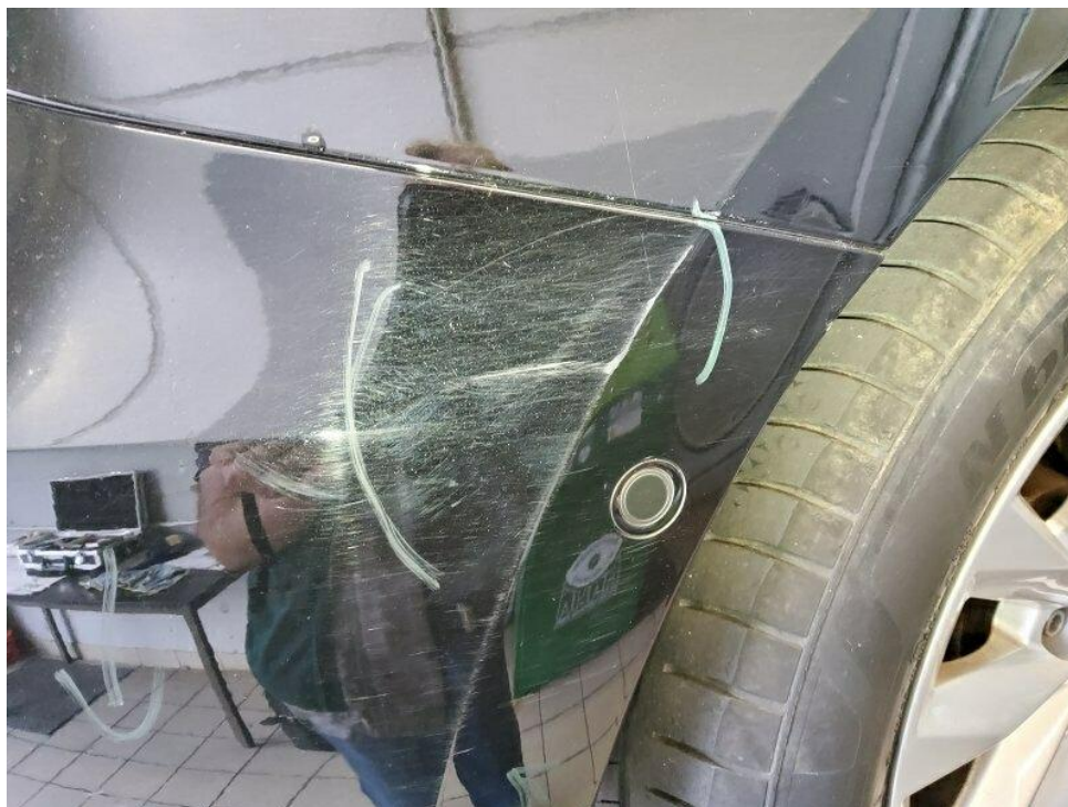
Bild 27 : Heckstoßfängerverkleidung rechts verschrammt bis Grundierung
