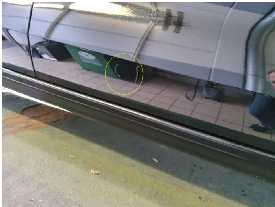
Bild 22 : Tür vorne rechts unten kleinere "weiche" Delle
