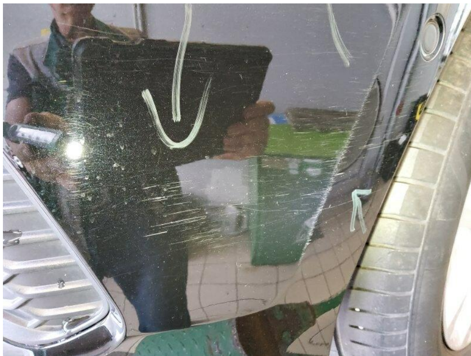
Bild 29 : Heckstoßfängerverkleidung rechts verschrammt bis Grundierung
