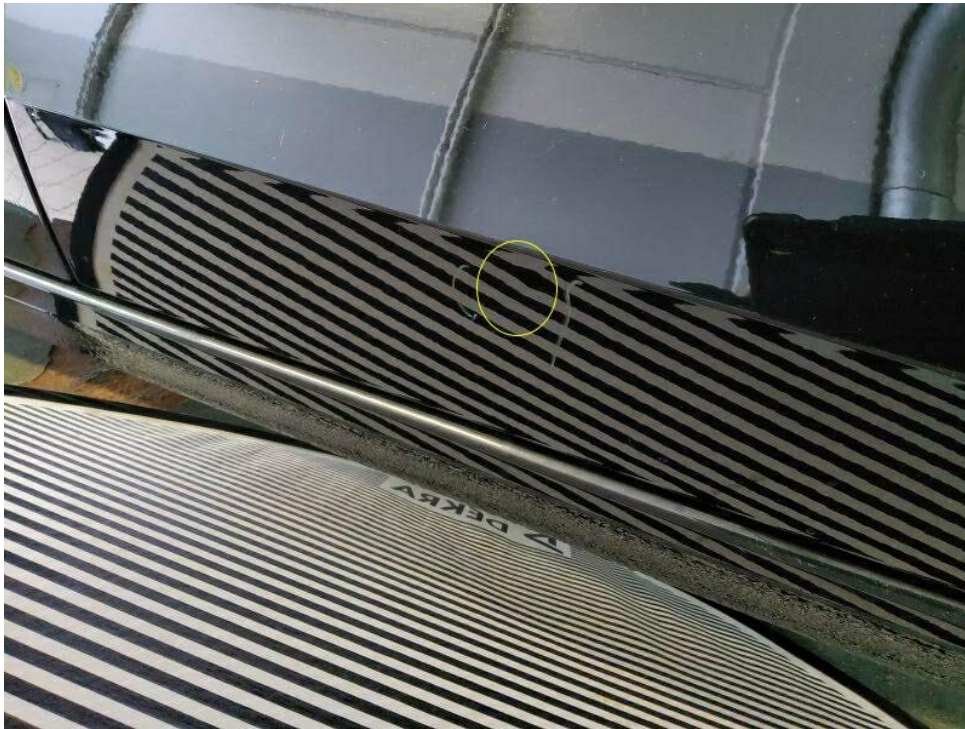
Bild 23 : Tür vorne rechts unten kleinere "weiche" Delle
