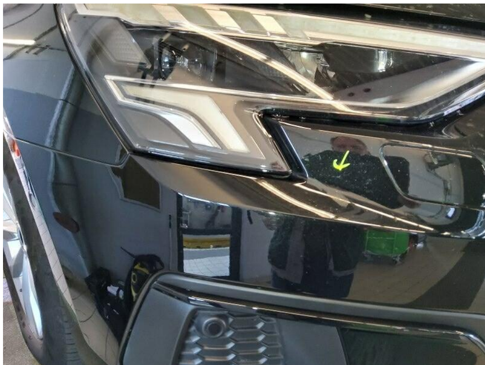
Bild 40 : Frontstoßfängerverkleidung verschrammt bis Grundierung
