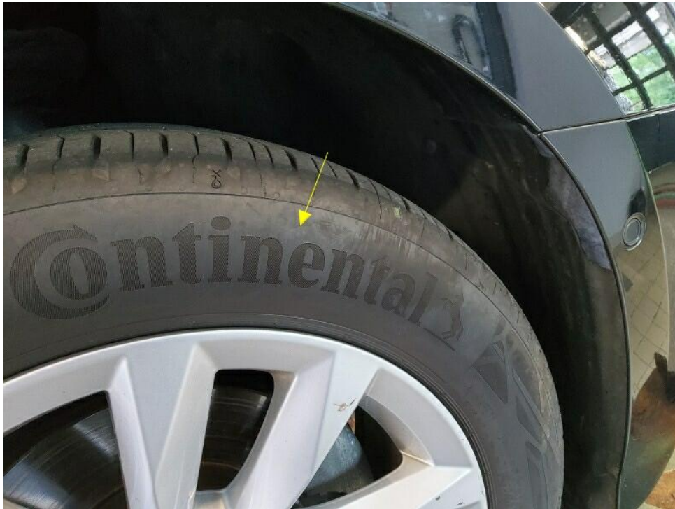
Bild 35 : Montierter Sommerreifen an der Vorderachse rechts weicht vom Hersteller der anderen Reifen ab
