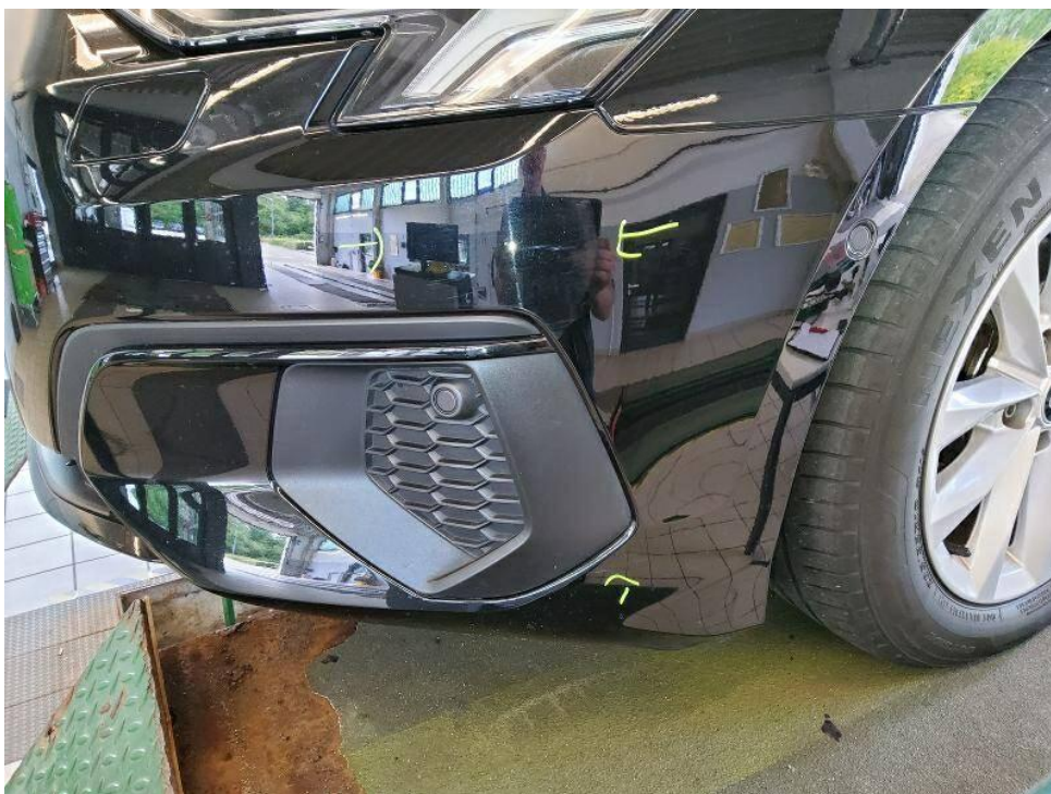
Bild 36 : Frontstoßfängerverkleidung verschrammt bis Grundierung
