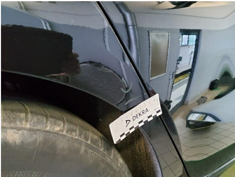
Bild 24 : Radlauf hinten rechts oberflächige Schramme
