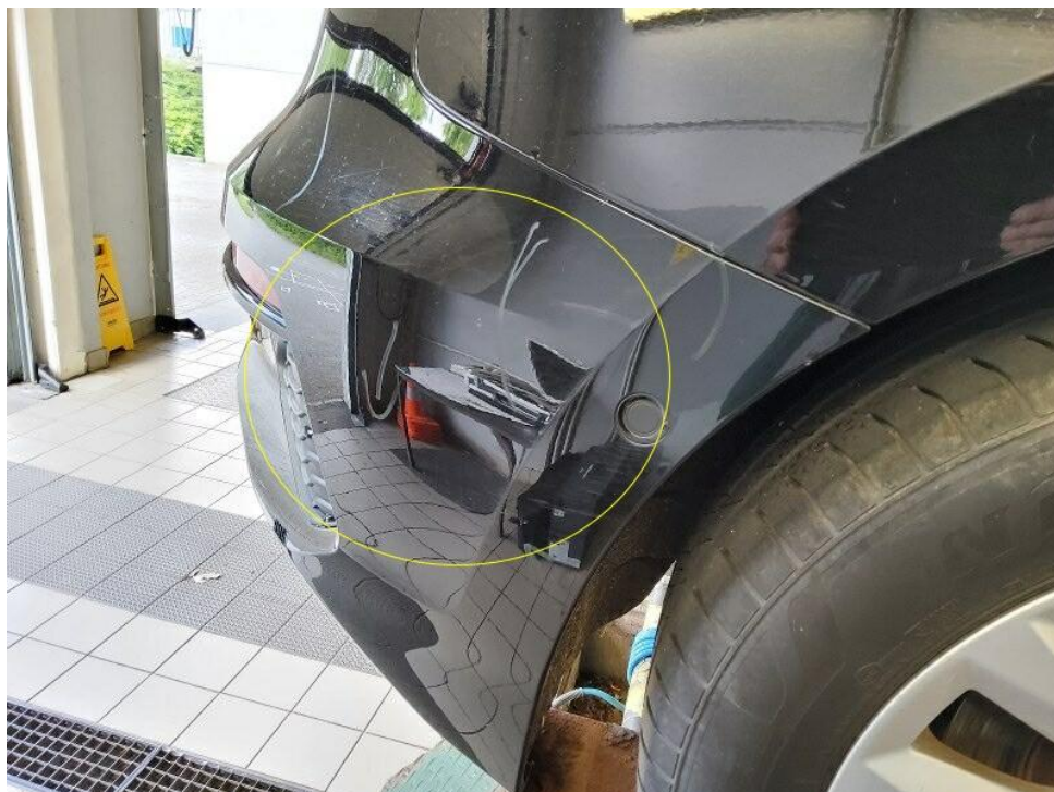
Bild 26 : Heckstoßfängerverkleidung rechts verschrammt bis Grundierung
