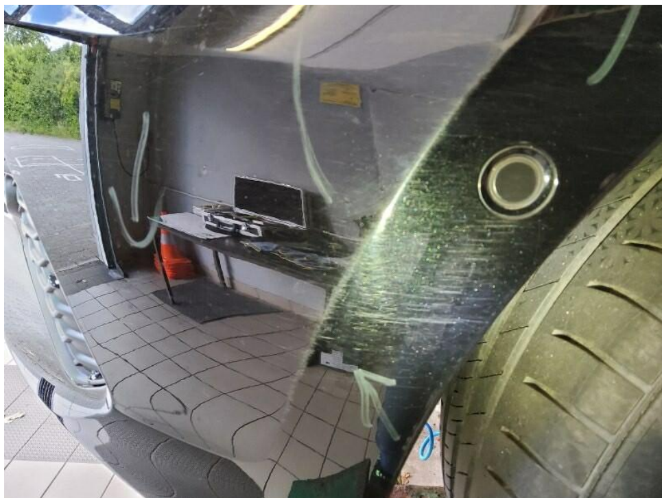
Bild 28 : Heckstoßfängerverkleidung rechts verschrammt bis Grundierung
