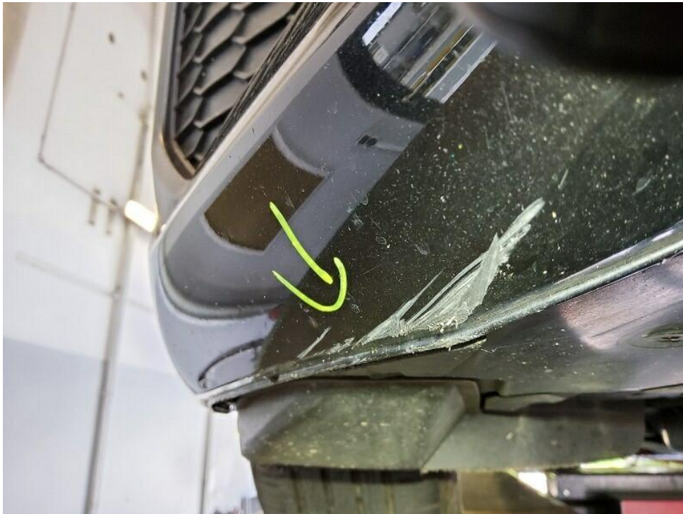
Bild 43 : Frontstoßfängerverkleidung verschrammt bis Grundierung
