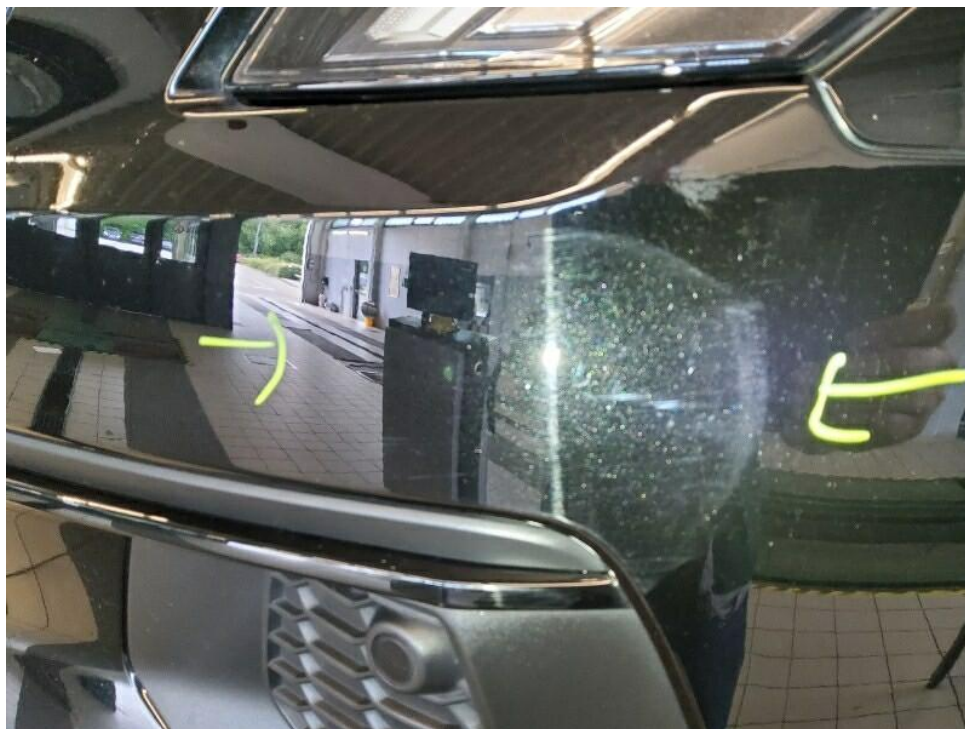
Bild 37 : Frontstoßfängerverkleidung verschrammt bis Grundierung
