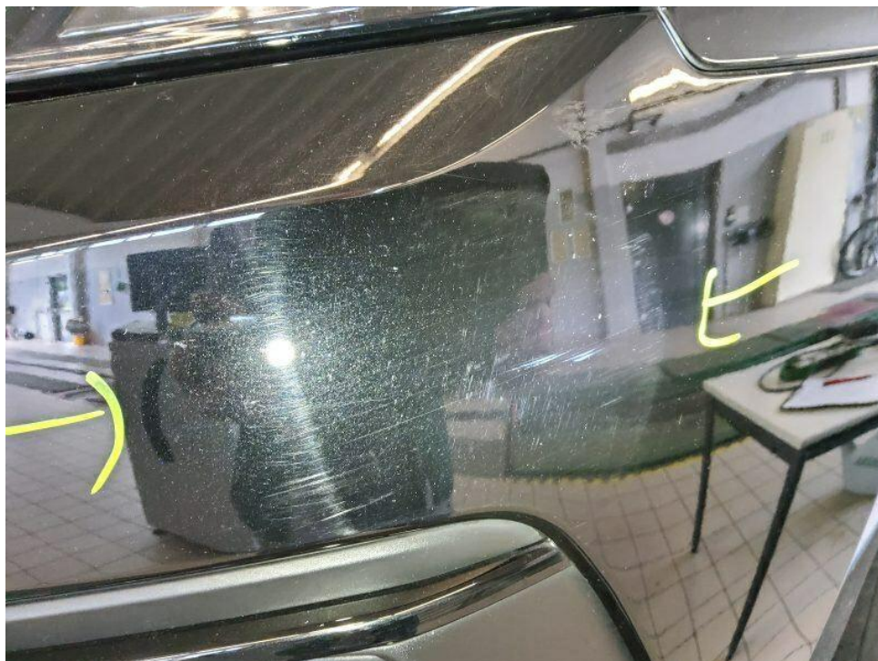
Bild 38 : Frontstoßfängerverkleidung verschrammt bis Grundierung
