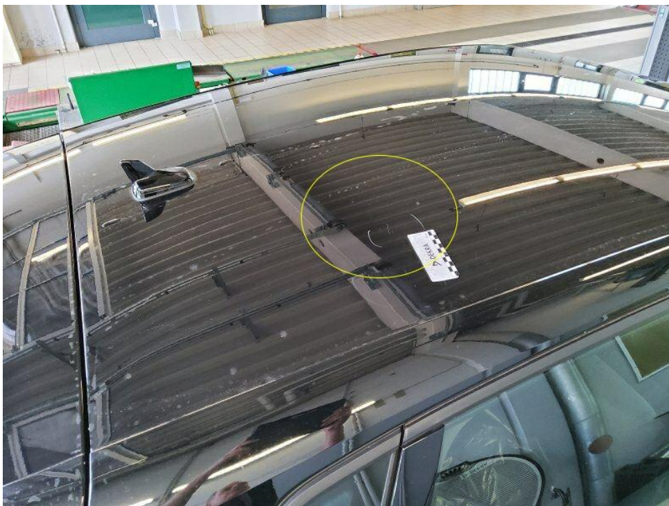
Bild 14 : Dach mehrere oberflächige Kratzer an diversen Stellen
