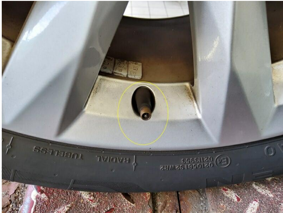
Bild 21 : Zwei Ventilstaubkappe rechts fehlen
