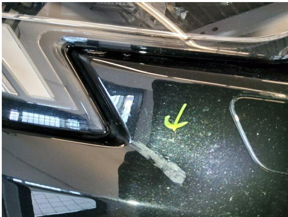
Bild 41 : Frontstoßfängerverkleidung verschrammt bis Grundierung
