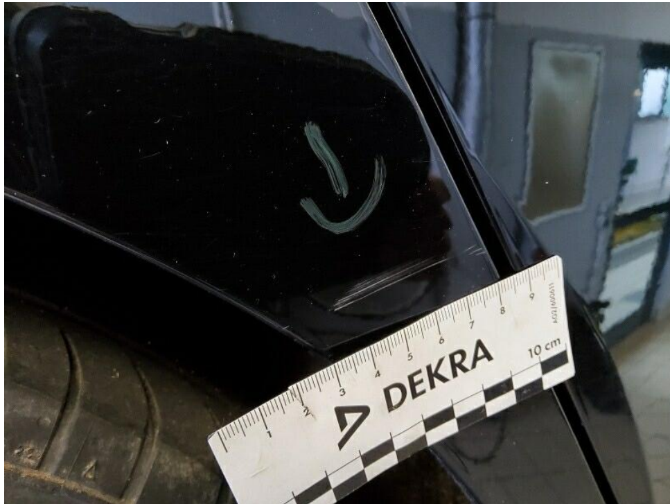
Bild 25 : Radlauf hinten rechts oberflächige Schramme
