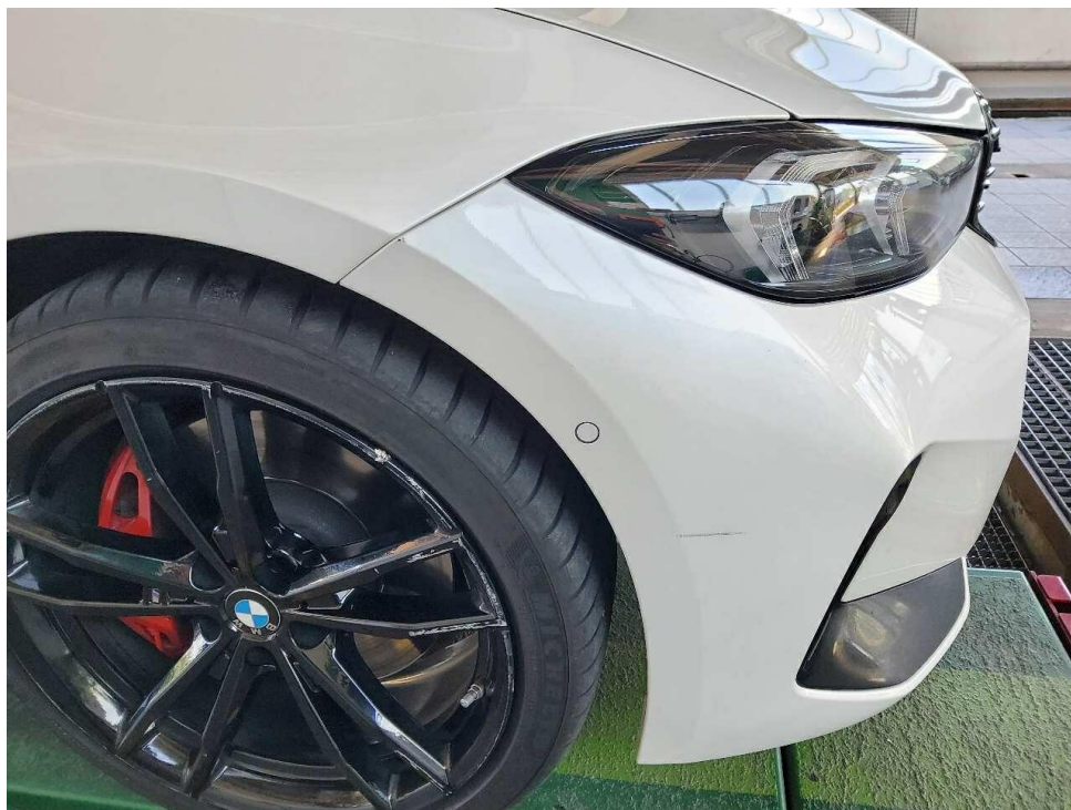
Bild 16 : Kotflügel und Stoßfänger vorn rechts verschrammt
