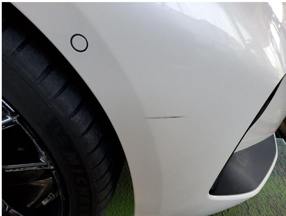
Bild 17 : Kotflügel und Stoßfänger vorn rechts verschrammt
