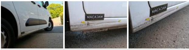
Door trim FR, Scratch(es), Replace
