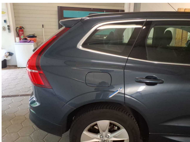
Beschädigung #2: Seitenwand rechts: Seitenwand - Kratzer - Smart Repair
