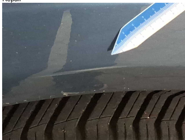
Beschädigung #2: Seitenwand rechts: Seitenwand - Kratzer - Smart Repair
