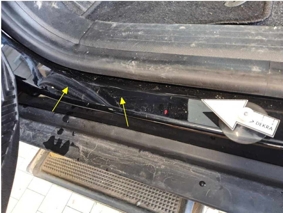
Bild 13 : Tür vorne links Einstieg Lackierung, zerkratzt, smart repair
