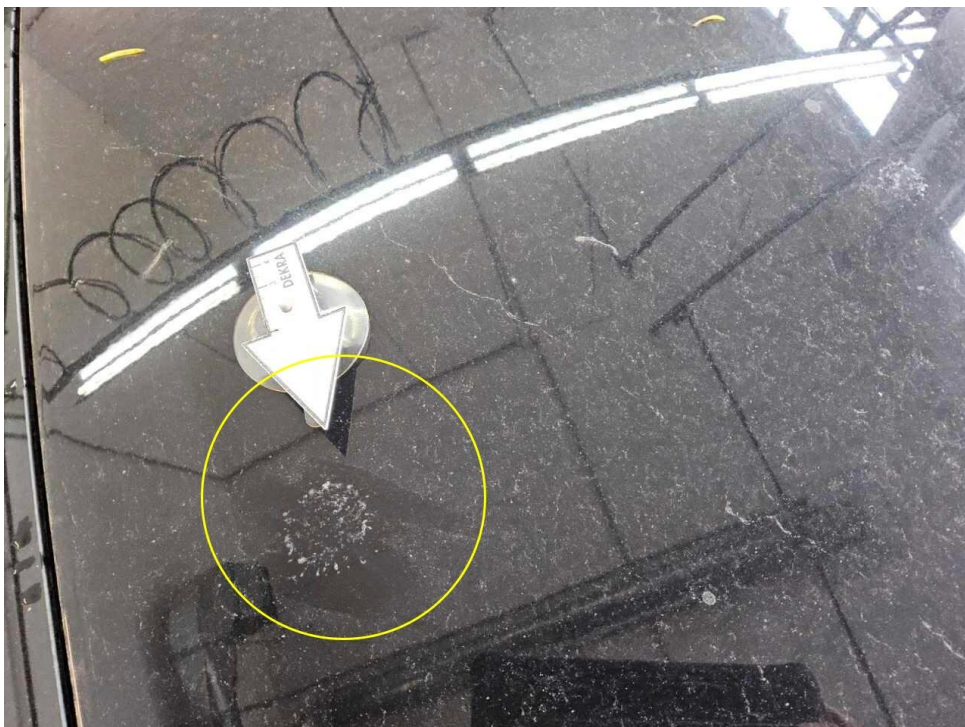
Bild 14 : Dach Lackierung, Umweltschaden, lackieren mit Lackaufbau
