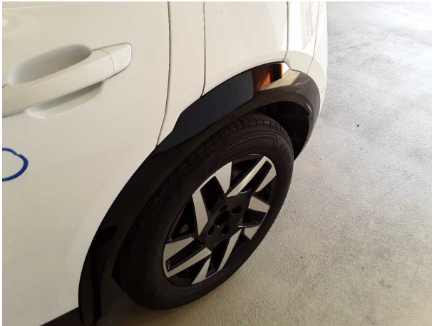
Beschädigung #1: Seitenwand links: Radhausverbreiterung - verkratzt / verschürft - Smart Repair
