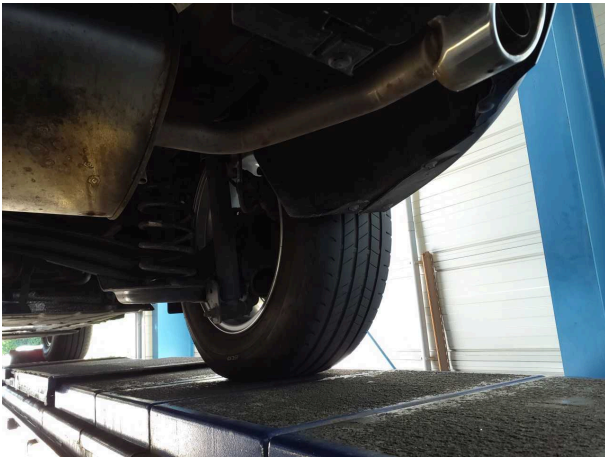
Beschädigung #4: Rad/Reifen: Reifensatz komplett - verschlissen - erneuern
