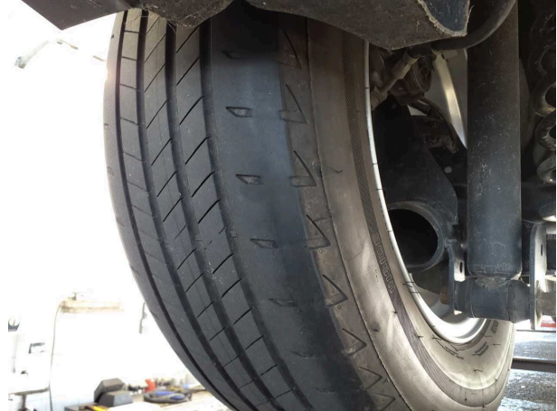
Beschädigung #4: Rad/Reifen: Reifensatz komplett - verschlissen - erneuern
