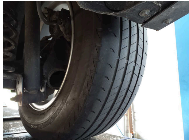
Beschädigung #4: Rad/Reifen: Reifensatz komplett - verschlissen - erneuern
