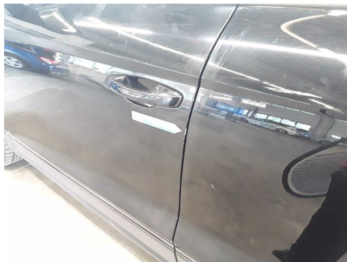
Damage 21: Door - front left side: Door - Scratch(es) - Paint
