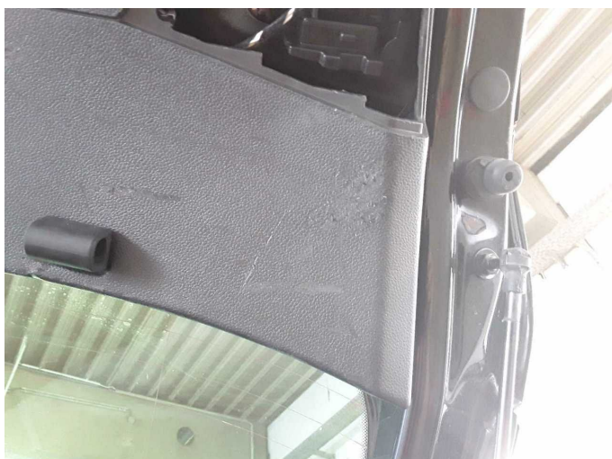
Damage 12: Trim / covers: Boot lining (Beschädigungen ebenfalls vorhanden) - Missing - Replace
